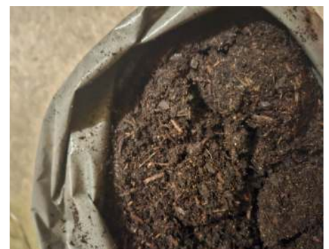
Rys. 2. Przykład gruntu organicznego – torf
