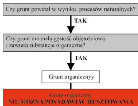
Rys. 3. Ścieżka klasyfikacji gruntu organicznego
