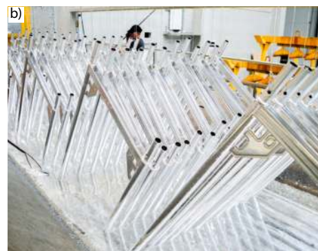
Fot. 3. Elementy w wannie cynkowniczej ocynkowni PIONART:
