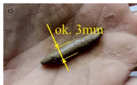
Rys. 6. Konsystencja twardoplastyczna: a) formowanie kulki, b) kulka, c) wałeczek
