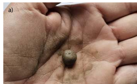
Rys. 6. Konsystencja twardoplastyczna: a) formowanie kulki, b) kulka, c) wałeczek
