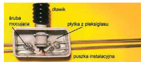
Rys. 3. Umocowanie i połączenia w puszcze instalacyjnej. Pod spodem znajduje się płytka z pleksigalsu
