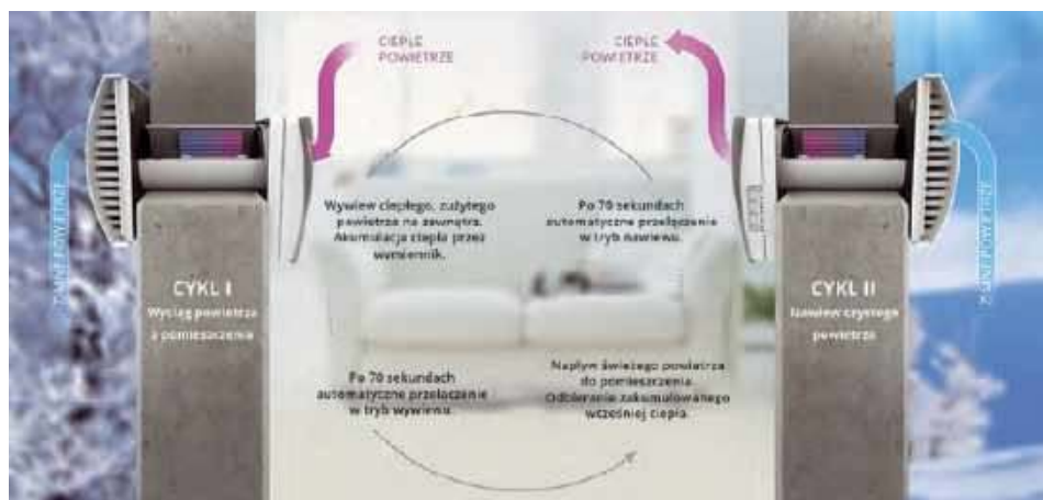
Odzysk ciepła w urządzeniu VENTO.
