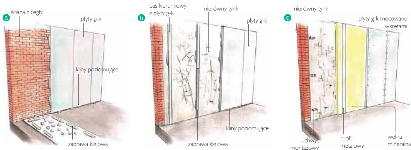
❶ Montaż tzw. suchego tynku (płyt g-k): na klej (a), na pasach z płyt (b) oraz na profilach stalowych (c).
