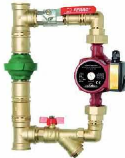
ⓘ Obejście z zaworem różnicowym umożliwia grawitacyjne działanie instalacji w razie awarii pompy lub przy braku zasilania. FERRO
