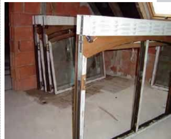
📌 Rolety nakładane zakłada się przy okazji wymiany stolarki – gotowe do osadzenia okna z już zamontowanymi roletami. ALUPLAST
