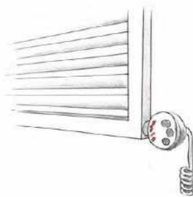
Rys. 6 Nie wolno podłączać grzałki poziomo, równoległe do szczelbeków. Taki układ nie zapewnia niezbędnego odbioru ciepła z grzałki.
