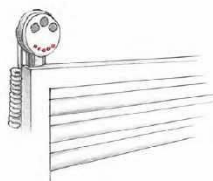
Rys. 7 Podłączenie grzałki pionowo w dół jest absolutnie niedopuszczalne. Grozi to jej przegrzaniem i zniszczeniem.
