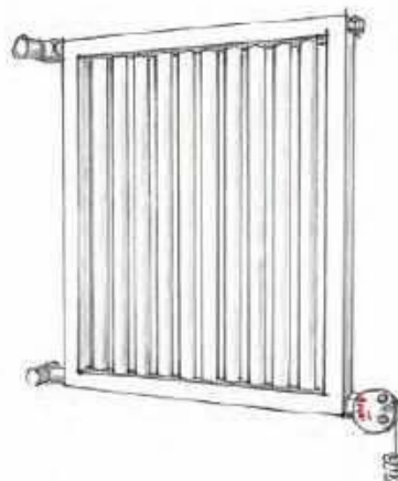
Rys. 5 Podłączenie poziome grzałki. Dopuszczalne warunkowo, tylko przy poprzecznym ustawieniu szczelbeków.
