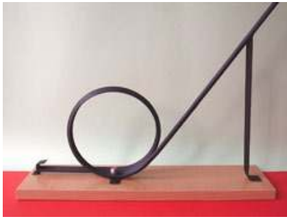
Rys. 7. (a) „Pętla śmierci” to proste, ale bardzo dydaktyczne zadanie na prawo zachowania energii. (b) Wyścigi elektrycznych samochodzików też zawierają pętlę śmierci, ale zaraz za nią pochylony w lewo zakręt: trzeba właściwie dobrać prędkość, aby siła odśrodkowa dostatecznie dociskała samochodzik do toru na szczycie pętli, ale nie „wyrzuciła” samochodzika z zakrętu (gra Pasza, 2003 rok).
