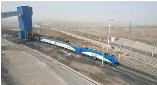
Rys. 9. Chińska lokomotywa na napęd wodorowy CRRC Zhunhou może ciągnąć 105 wagonów. Źródło: Mat. informacyjne portalu Rynek Kolejowy, rynek-kolejowy.pl
