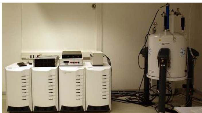
Fot. 1. Spektrometr NMR 400 MHz z magnesem 9.4 T przeznaczony jest do badań fazy skondensowanej oraz cieczy w szerokim zakresie temperatur.
