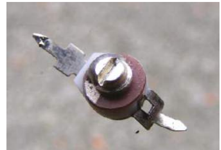
Rysunek 16. Tanie trymery ceramiczne, takie jak ten firmy Murata, nie są zbyt stabilne pracując w obwodach Theremina.
