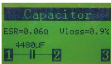
Rysunek 6.11. Niektóre tanie testery komponentów zawierają możliwość wykonania pomiaru ESR kondensatora. W tym przypadku badany jest dobrej jakości kondensator osiowy 4700 µF.
