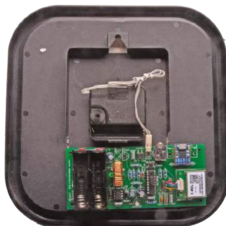
Oto jak przymocowaliśmy płytkę do zegara wskazówkowego – trochę pitowania dla usunięcia kilku występow, a następnie kilka kropel silikonowego uszczelnacza jako kleju. Pokazany sposób mocowania, umożliwił późniejszą łatwą wymianę baterii.
