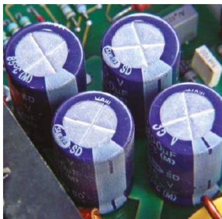
Rysunek 6.6. Cztery duże kondensatory elektrolityczne połączone równolegle w celu utworzenia dużej pojemności filtrującej na wejściu wysokociępieniowego zasilacza impulsowego DC.
