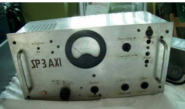
Nadajnik 144 MHz AM/CW skonstruowany przez SP3AXI/SK (lata 60.)
