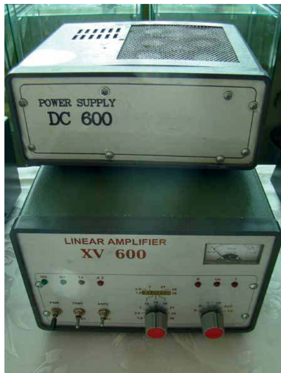
Liniowy wzmacniacz tranzystorowy 600 W konstrukcji SP3CY (1991)
