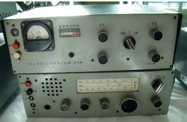
Transceiver 3-pasmowy 3,7/7/14 MHz skonstruowany przez SP3BPU dla klubu SP3ZHW (lata 70.)
