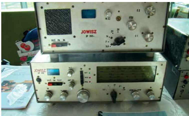
Transceivery 5-pasmowe Jowisz SP102-112 produkowane w Postominie na wyposażenie klubów SP (1975–1990)
