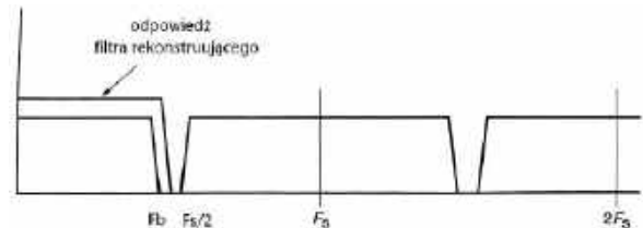
Rysunek 11. Odpowiedź częstotliwościowa rzeczywistego filtra rekonstruującego
