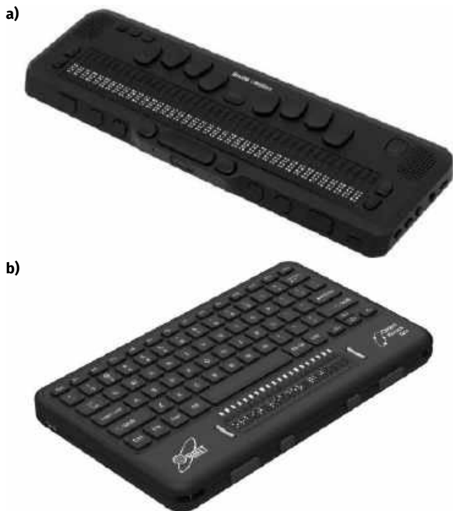
Fotografia 11. Linijki brajlowskie: 40-znakowa linijka Braille eMotion z klawiaturą brajlowską (a) oraz linijka 20-znakowa z klawiaturą QWERTY Orbit Reader Q20 (b). Oba urządzenia mają zestaw dodatkowych przycisków, dwa po bokach (do przewijania tekstu) oraz przyciski dla każdego znaku do pozycjonowania kursora
