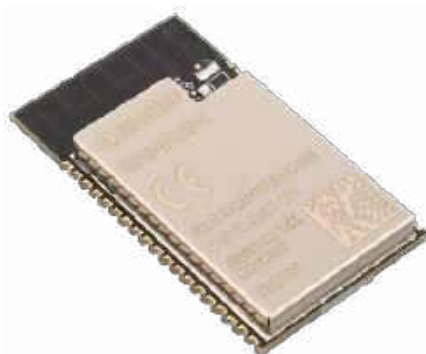
Fotografia 2. Popularny moduł ESP32 z serii WROVER (ESP32-WROVER-E-N8R8) z padami lutowniczymi typu castellated ( https://t.ly/pKMvl )
