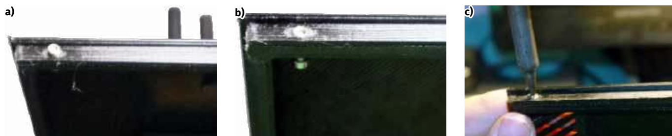
Fotografia 2. Instalacja wkładek gwintowanych w panelu bocznym: przed przyłożeniem rozgrzanego grota (a) i po (b). Wtapiając tuleję, należy postępować ostrożnie i uważać, by grot lutownicy był umieszczony prostopadle do osi otworu (c)
