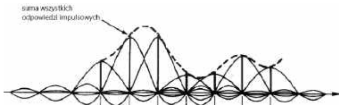
Rysunek 6. Odtworzenie oryginalnego przebiegu na wyjściu przetwornika
