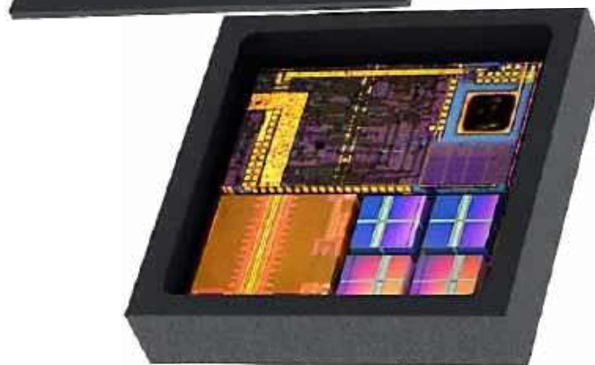
Rysunek 7. Budowa ultraminiatury modułu BLE 4.2 – BGM121N256 marki Silicon Labs o wymiarach 6,5 × 6,5 × 1,4 mm ( https://t.ly/auQtw )
