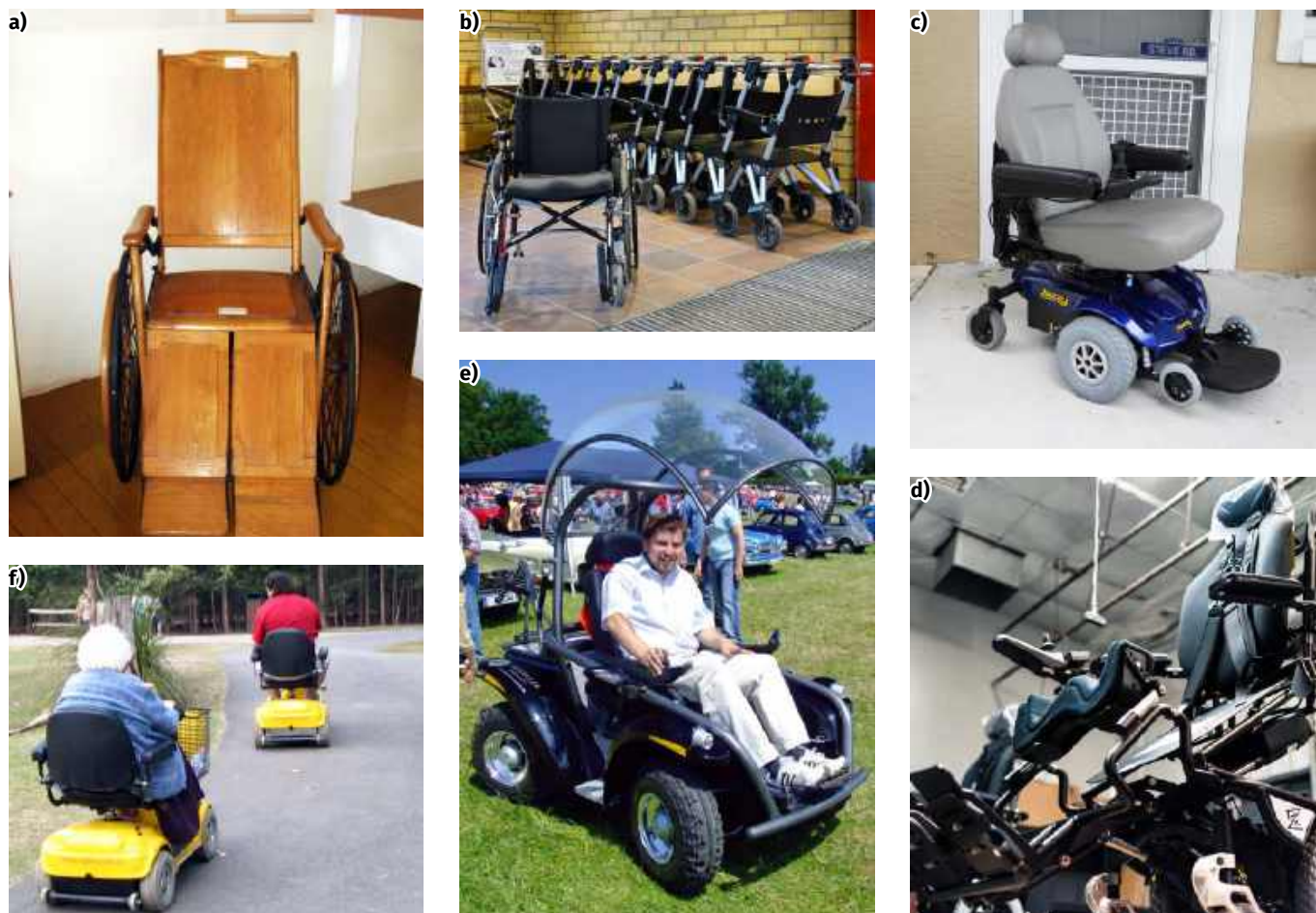
Fotografia 16. Wózki inwalidzkie różnych typów: drewniany wózek z początku XX wieku (a), współczesne wózki inwalidzkie: model składany i modele wsuwane jeden w drugi, w szwedzkim szpitalu (b), wózek elektryczny z napędem na przednie koła i siedziskiem „kapitańskim” (c), pionizator (d), wózek terenowy (e), skutery dla niepełnosprawnych (f). Źródło: Wikipedia.org
