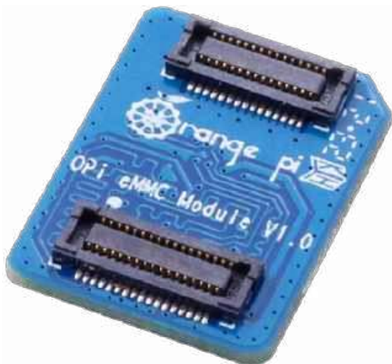
Fotografia 19. Moduł z pamięcią eMMC do minikomputerów SBC z serii Orange Pi ( https://t.ly/COTcZ )
