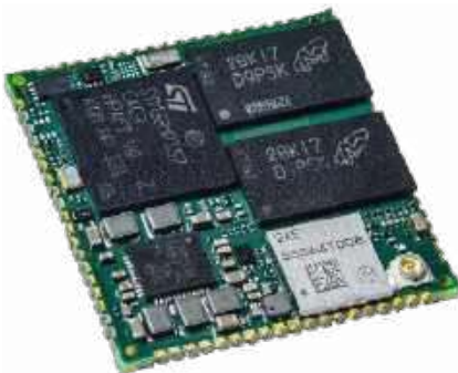
Fotografia 4. Minikomputer SoM jako przykład modułu OEM o dużej gęstości upakowania elementów ( https://t.ly/EAZn5 )
