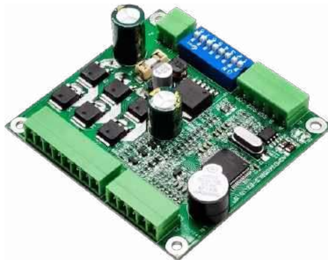
Fotografia 21. Moduł sterownika silników BLDC ze listwami rozłączalnymi ( https://t.ly/i7WZU )
