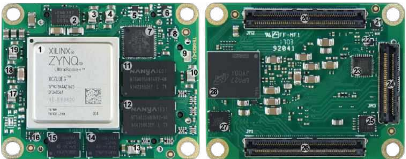
Fotografia 18. Zaawansowany moduł SoM z macierzą FPGA. Opis oznaczeń liczbowych dostępny w dokumentacji: https://t.ly/r9gYh
