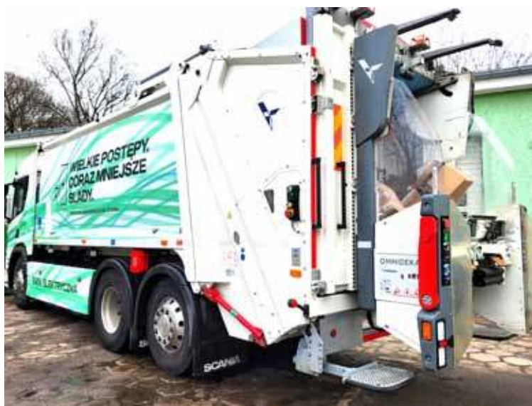
Elektryczna śmieciarka po jednorazowym naładowaniu baterii może przejechać od 140 do 160 kilometrów
