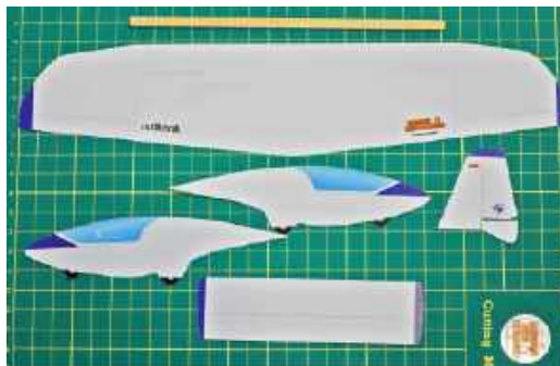
Wszystkie kartonowe elementy szybowca oraz listwa krawędzi natarcia (też warto ją pomalować). Przed klejeniem warto zbiżować krawędzie (linie przerywane na skrzydłach, ew. krawędzie sterów)
