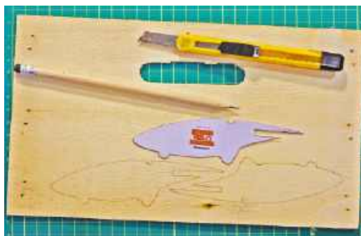
Po wycięciu szablonu kadłuba odrysowujemy go na lekkiej sklejkce i wycinamy piłą włoścnicową (przy odrobinie zacięcia i cierpliwości nawet nożem do tapet)
