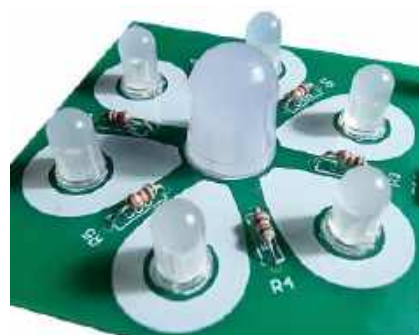
Fotografia 12. Poprawnie zamontowane diody LED. Kierunek montażu wszystkich diod LED należy dopełniać zgodnie z opisem powyżej. W centralnej części kwiatka należy zamontować największą diodę LED, tę o średnicy 10 mm
