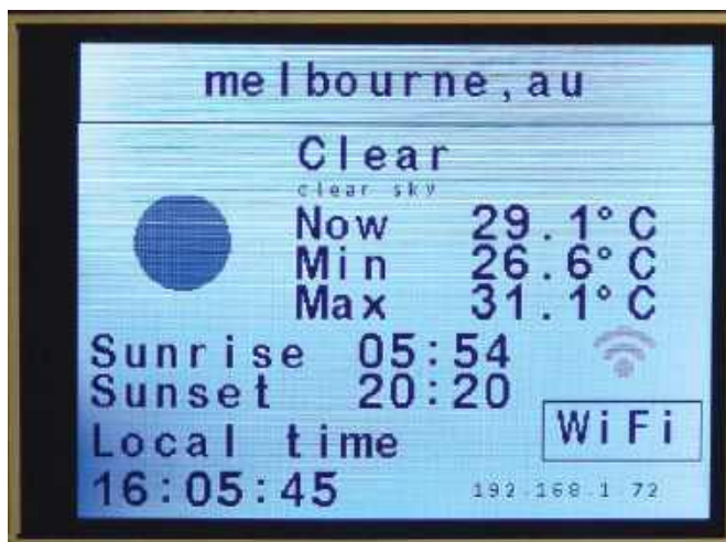
Ekran 5. Jeśli moduł został prawidłowo zmontowany i zaprogramowany, po połączeniu się z siecią Wi-Fi powinien podawać lokalne dane pogodowe
