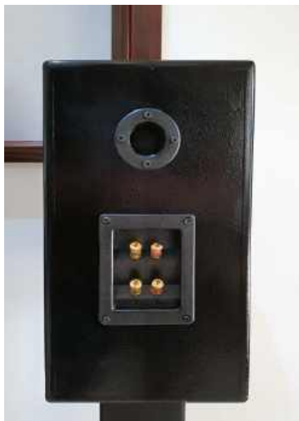
Fotografia 7. Tył głośnika z widoczną teksturą, którą można uzyskać, jeśli nie przeszlifuje się podkładu. Dobrze widoczny jest również otwór wentylacyjny i zaciski
