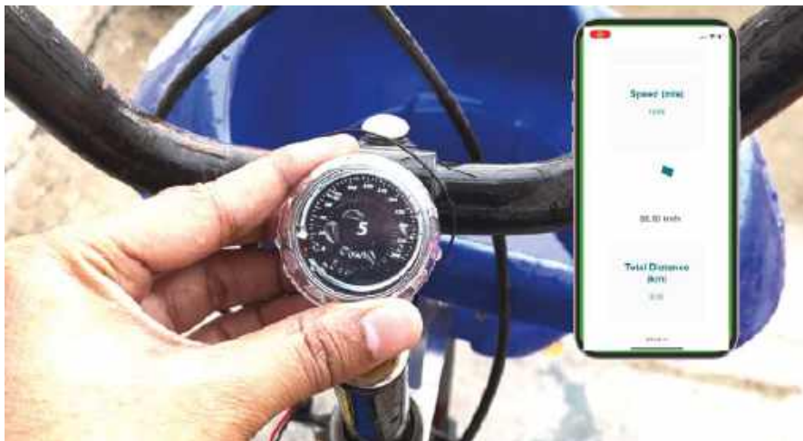
Rysunek 1. Autorski egzemplarz prędkościomierza GPS, użyty w rowerze
