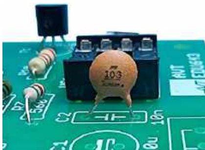
Fotografia 8. Montaż kondensatora stałego C2. Kierunek montażu jest obojętny. Na obudowie kondensatora widać napis „103” informujący o pojemności 10 i 3 zera pikofarów (10000 pF) czyli 10 nF
