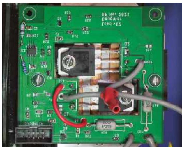
Rysunek 15. Płyta dodatkowa ma dwa moduły zasilania i układ scalony monitora prądu, identyczne z tymi na płycie głównej. Sygnały sterujące oraz z czujników są przesyłane do płyty głównej taśmką. Należy zauważyć, że układ płyty głównej uległ znacznym zmianom od czasu wykonania zdjęcia
