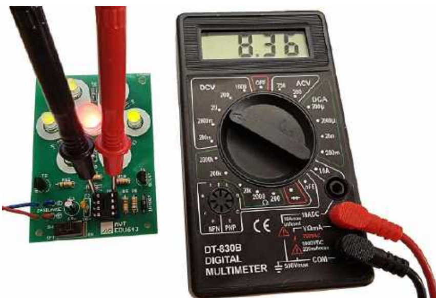
Fotografia 17. Pomiar na zaciskach 8 („plus”) i 1 („minus”) podstawki pod układ NE555 wykazał poprawne napięcie baterii (bez znaku „-”, który sugerowałby błędną polaryzację). Można odłączyć zasilanie i zamontować układ scalony w podstawce
