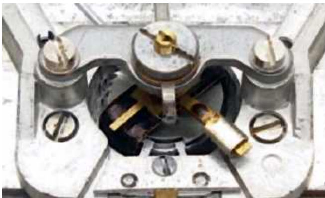
Ustrój pomiarowy słynnego Modelu 8 firmy AVO (© Peter Vis)
