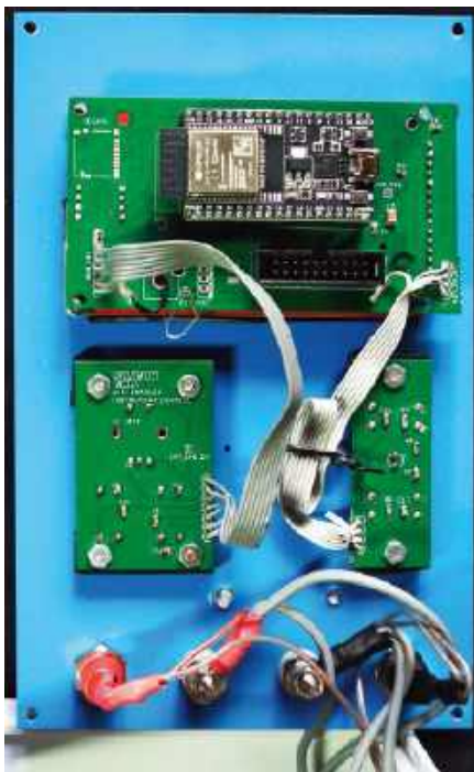
Płytkę sterującą można pociąć na trzy oddzielne fragmenty, a następnie połączyć taśmą. Jeśli używasz wystarczająco dużej obudowy, płytki nie muszą być cięte
