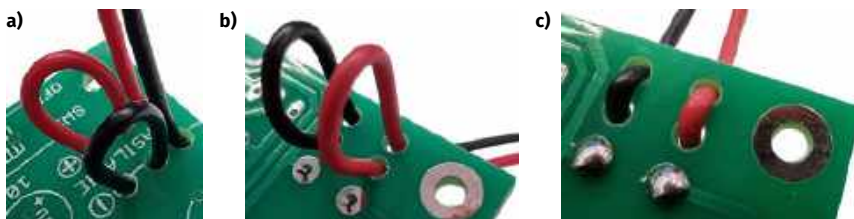
Fotografia 15. Kabelki złącza baterii należy a) przeprowadzić przez otwory pomocnicze od strony komponentów, b) następnie patrząc „od spodu” przetoczyć je przez kolejną parę otworów, c) i na końcu przylutować odizolowane i pocynowane wcześniej końcówki kabelków do odpowiednich pól lutowniczych na płytce PCB
