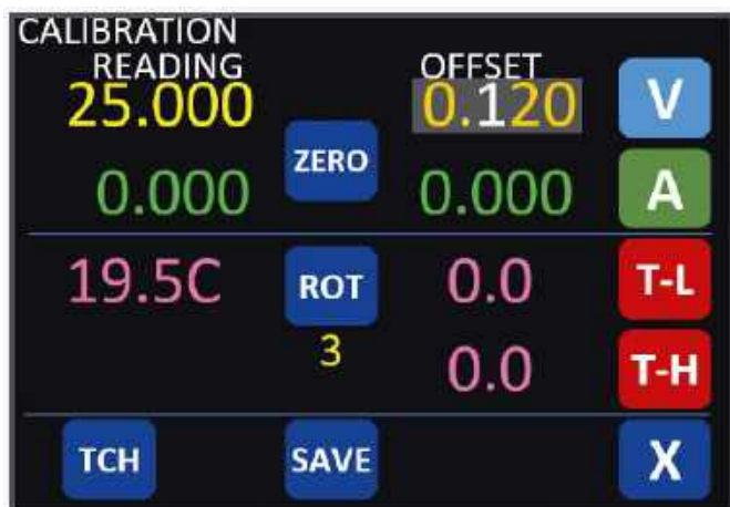
Ekran 6. Na ekranie startowym naciśnięcie przycisku SET w prawym górnym rogu powoduje przejście do ekranu kalibracji. Naciśnięcie przycisku ROT na środku tego ekranu dostosuje kierunek wyświetlacza, jeśli dotykowe elementy sterujące są odwrócone
