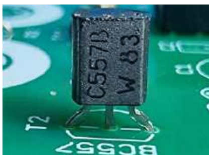
Fotografia 7. Montaż dwóch różnych tranzystorów T1 i T2. Należy upewnić się, że na pozycji T1 montowany jest typ a). BC547 a na pozycji T2 b). BC557. Korpusy tranzystorów (w kształcie litery „D”) odpowiadają obrysom (również w kształcie litery „D”) na warstwie opisowej płytki PCB
