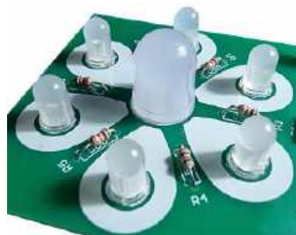
Fotografia 12. Poprawnie zamontowane diody LED. Kierunek montażu wszystkich diod LED należy dopilnować zgodnie z opisem powyżej. W centralnej części kwiatka należy zamontować największą diodę LED, tę o średnicy 10 mm
