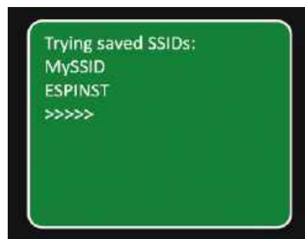
Ekran 7. Po zaprogramowaniu płytki sterownika, po pierwszym włączeniu zasilania powinien zostać wyświetlony powyższy ekran. Jest to program próbujący połączyć się z lokalnym adresem Wi-Fi LAN
