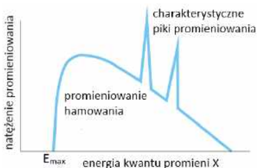
5. Przykładowy kształt widma promieniowania emitowanego z lampy rentgenowskiej
