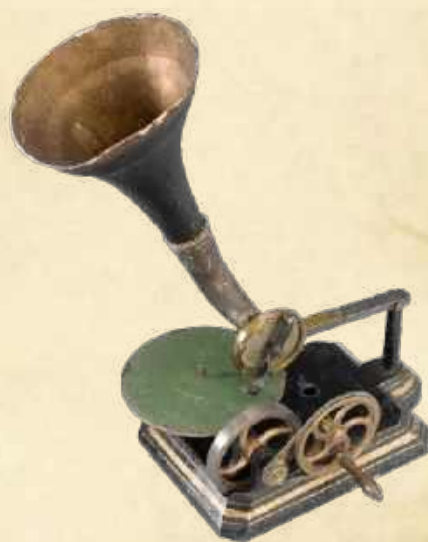
3. Gramofon Berlinera z tubą i płytą szelakową. Źródło: By Science Museum – Science Museum, CCO, https://commons.wikimedia.org/w/index.php?curid=6859258
