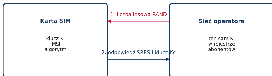
Rysunek 1. Uwierzytelnianie w sieci komórkowej. Klucz nigdy nie opuszcza karty
