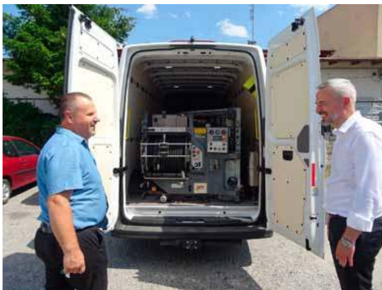
Półciężarówka MAN jako WUKO - czyli maszyna do czyszczenia sieci
