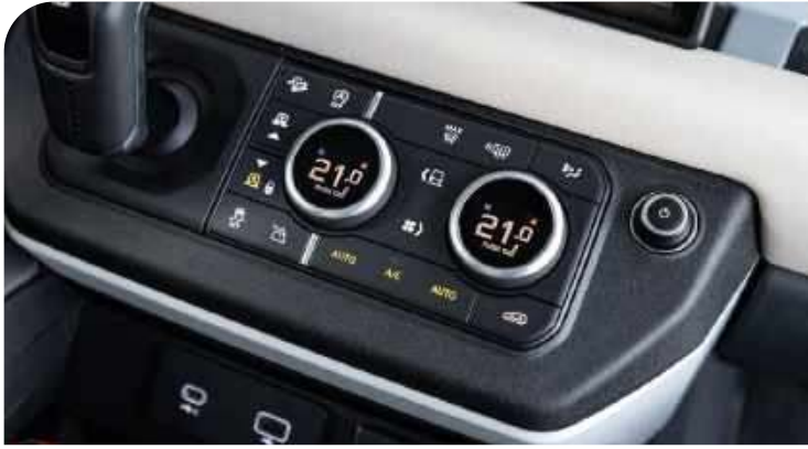
Po wybraniu zaawansowanego asystenta holowania panel z pokrętłami klimatyzacji zamienia się w centrum sterowania cofaniem przyczepy; pokrętło zastępuje kierownicę
