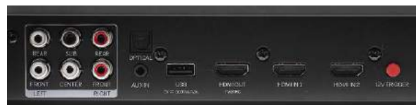
Panel przyłączeniowy prezentuje się wyjątkowo, obejmuje dwa wejścia HDMI i unikalną sekcję wyjść niskopoziomowych formatu 5.1.
