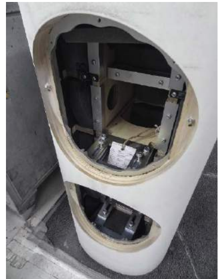
Stalowe elementy przedłużają łączą szkielet z przednią ścianką, także wzmocnioną warstwą aluminium.
