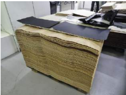
Podstawowym tworzywem obudów serii 800 jest sklejka, którą Bowers produkuje sam z pojedynczych warstw obłogów.
