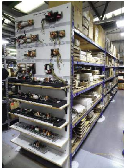
Wzorcownia, w której przechowywane są referencyjne egzemplarze zwoznic wszystkich modeli.
