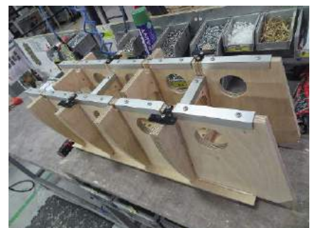
Wewnętrzne wzmocnienie tworzą szkielet wykonany ze sklejki i wzmocniony aluminium profilami.
