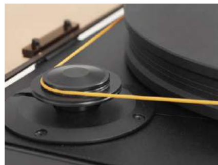
Prędkość obrotową zmieniamy przekładając pasek na właściwą rolkę.
