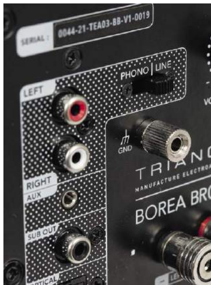
Cennym elementem wyposażenia jest wejście gramofonowe; układ korekcji przygotowała firma Pro-Ject.
