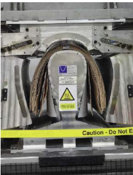
Wielka prasa wygina na „kopycie” odpowiednią liczbę warstw (zależną od modelu) i jednocześnie skleja je w wysokiej temperaturze.
