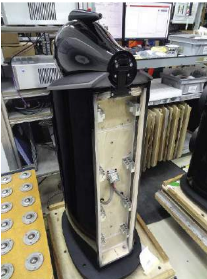
Wydzieloną komorę z tyłu obudowy zajmie zwoznica zainstalowana do aluminiowego panelu.
