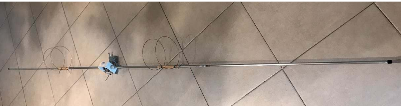
Antena balkonowa na 2 m po złożeniu
