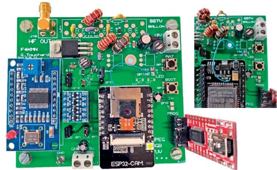
Widok nadajnika. Syntezator znajduje się na niebieskiej płytce po lewej stronie, a układ programatora dla ESP32 – na pionowej płytce po prawej. Powyżej modułu ESP32CAM widoczne jest połączenie (wykonane niebieskim przewodem) pozwalające na regulację wzmacnienia stopnia mocy
