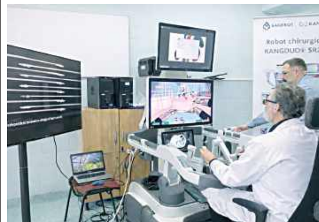
Wyposażony jest w cztery zrobotyzowane ramiona narzędziowe w systemie kolumnowym. Został zaprojektowany, by wspierać chirurgów w wykonywaniu precyzyjnych i małoinwazyjnych operacji
