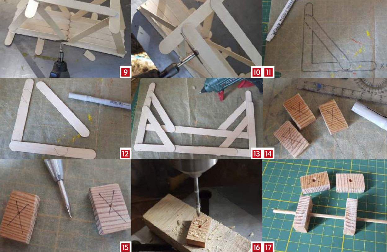
9. Odcinanie zbędnych części poprzeczek gumówką; 10. Należy uważać, żeby nie złamać delikatnej tarczki tnącej; 11. Wzór części przyczółku; 12. Można przystąpić do klejenia czterech jednakowych elementów; 13. Gotowe części przyczółków; 14. Elementy zawiasów zrobione z odcinków listwy; 15. Wyznaczanie środków i napunktowanie materiału; 16. Wiertarka kolumnowa zapewni prostopadłość wierzonego otworu; 17. Przymiarka do konstrukcji zawiasu
