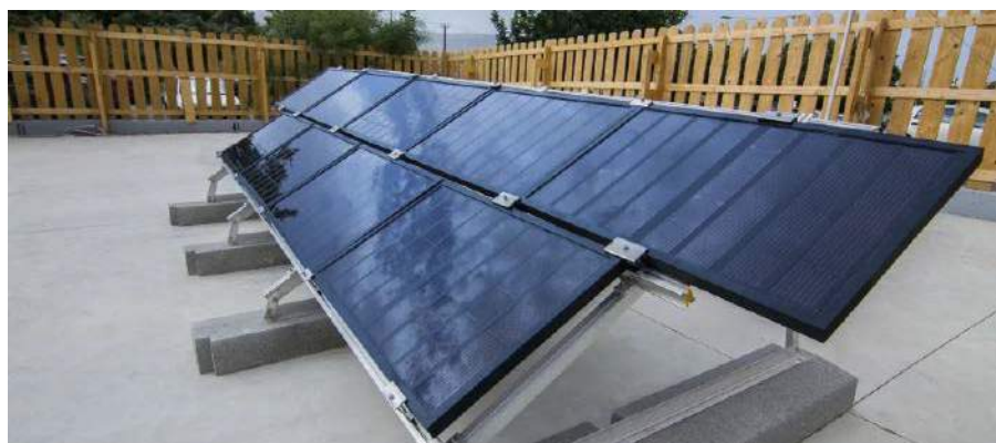
2. Perowskitowe ogniwa słoneczne wykorzystujące warstwy grafenowe testowane na greckiej wyspie Kreta
