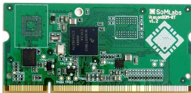
Fotografia 4. Komputer SoM marki SoMLabs, przygotowany do pracy z systemami czasu rzeczywistego (model VisionSOM-RT)
