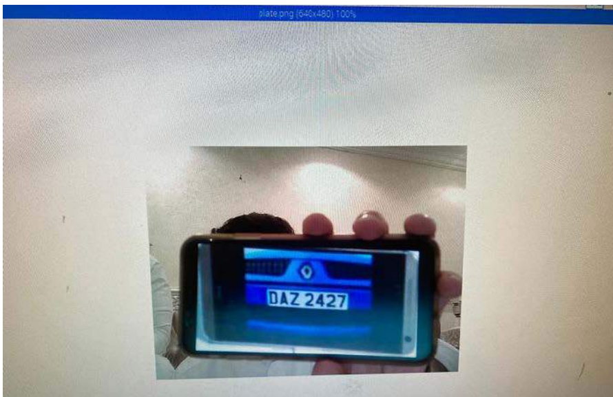
Fotografia 3. Prosty sposób na przetestowanie systemu – umieszczenie zdjęcia tablicy rejestracyjnej przed kamerą
