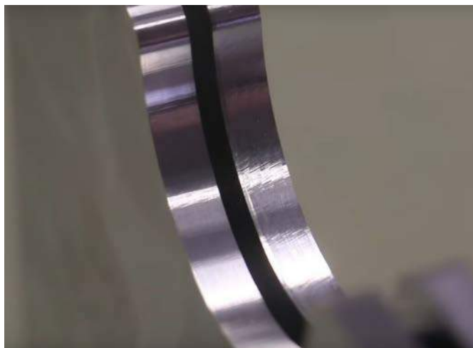
Fotografia 4. Efekt wykończenia krawędzi płyty aluminiowej po cięciu CNC z chłodzeniem – element po lewej stronie i bez chłodzenia – element po prawej stronie ( https://youtu.be/AzZBgJBai_k )
