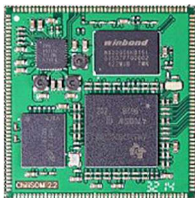
Fotografia 24. Moduł chiliSOM wrocławskiej firmy Grinn
