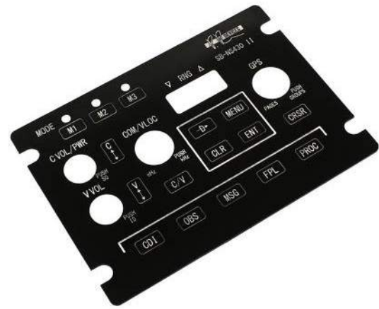
Fotografia 12. Panel czołowy wykonany z aluminium grawerowanego laserowo ( https://bit.ly/3AwCl0m )
