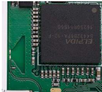
Fotografia 7. Antena minikomputera Raspberry Pi Zero W, zaprojektowana na licencji Niche marki Proant
