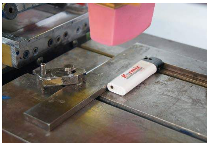
Fotografia 9. Kolorowy tampodruk na powierzchni tworzywowej zbiornika zapalniczki. Widoczny silikonowy stempel, służący do przenoszenia farby – górny element. ( https://bit.ly/3lG8V9L )
