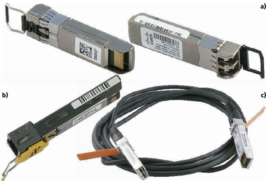
Fotografia 1. Przykładowe komponenty SFP: a) moduły światłowodowe; b) moduł z RJ45; c) kabel DAC
