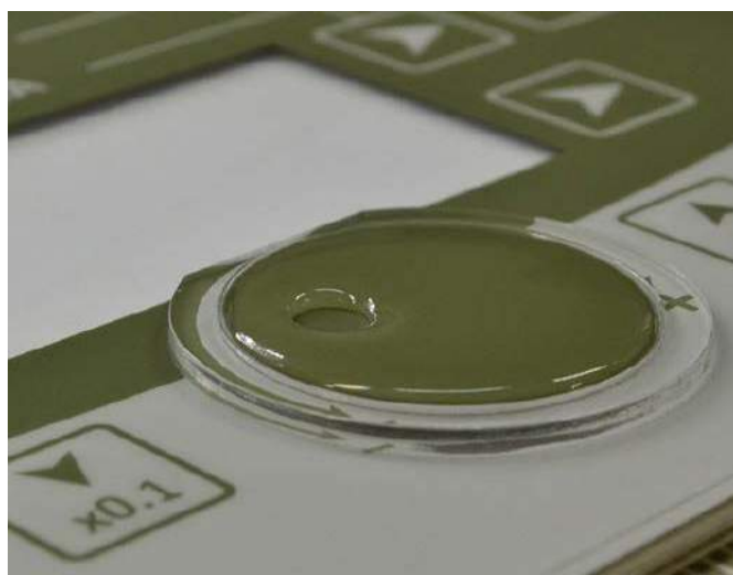
Fotografia 17. Pokrętło magnetyczne zintegrowane z panelem czołowym ( https://bit.ly/3nPNmpN )
