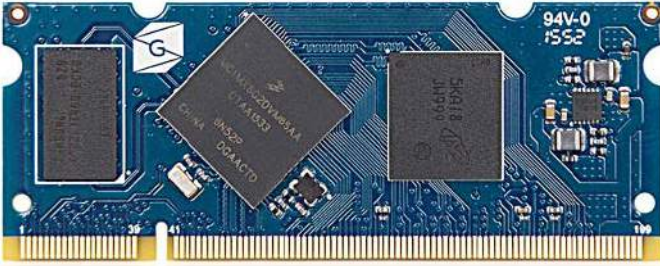
Fotografia 2. Przykładowy minikomputer typu SoM (LiteSOM marki Grinn) ze złączem krawędziowym typu SODIMM
