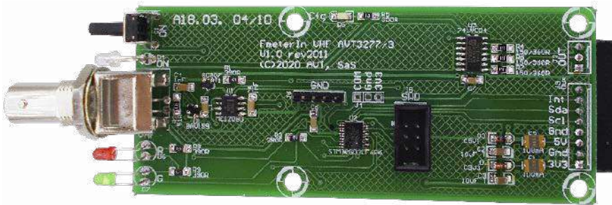
Fotografia 4. Zmontowana płytka wzmacniacza sygnału VHF (AVT3277/3)
