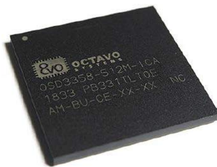
Fotografia 25. Minikomputer SiP typu OSD335x C-SiP marki Octavo Systems
