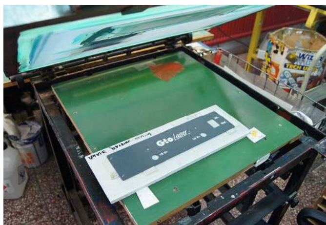
Fotografia 8. Prosty nadruk monochromatyczny na panelu czołowym, wykonany metodą sitodruku ( https://bit.ly/3lG8V9L )
