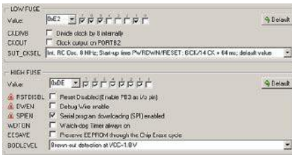
Rysunek 4. Konfiguracja bitów zabezpieczających w programie BitBurner
