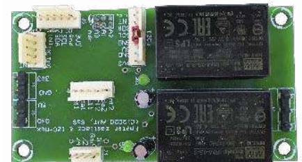
Fotografia 6. Zmontowana płytka zasilacza do wzmacniaczy sygnału (AVT3277/ZAS)
