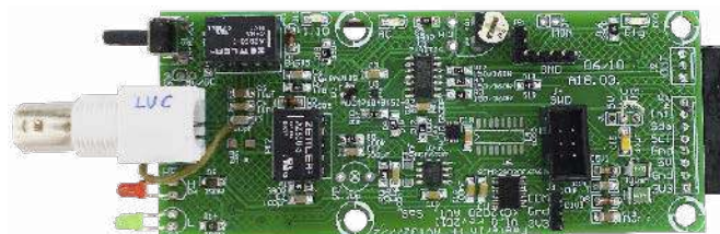
Fotografia 3. Zmontowana płytka wzmacniacza sygnału HF (AVT3277/2)
