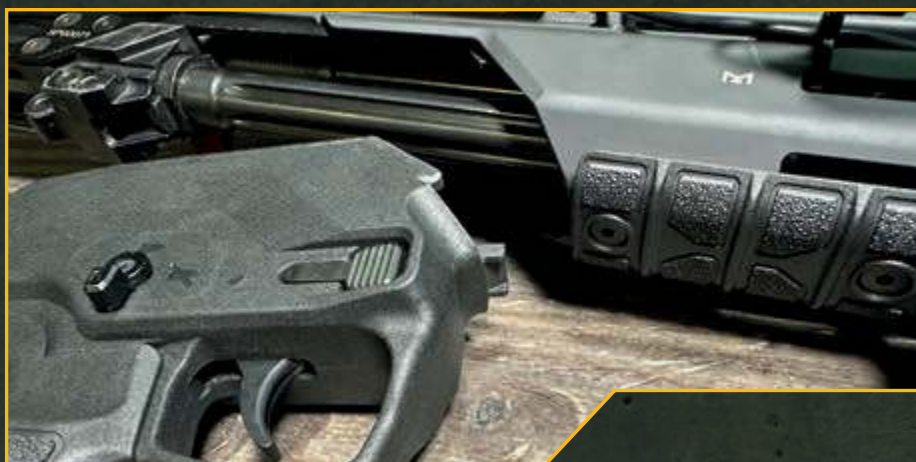
Sposób podpinania komory spustowej przy zamocowanym łożu
