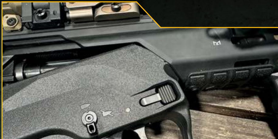
Sposób podpinania komory spustowej przy zamocowanym łożu
