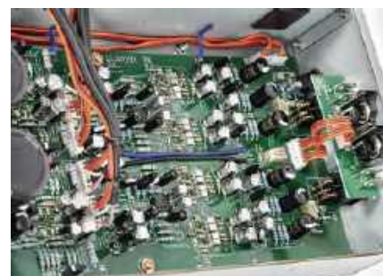
Na płytce analogowej widać oddzielenie torów obydwu kanałów.
