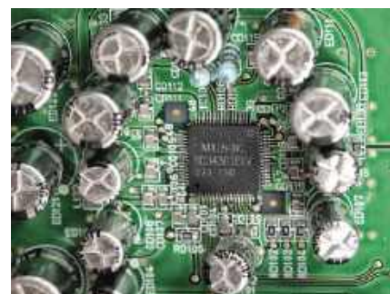
Luxman, jako jeden z nielicznych producentów stosuje przetworniki cyfrowo-analogowe firmy ROHM Semiconductor.
