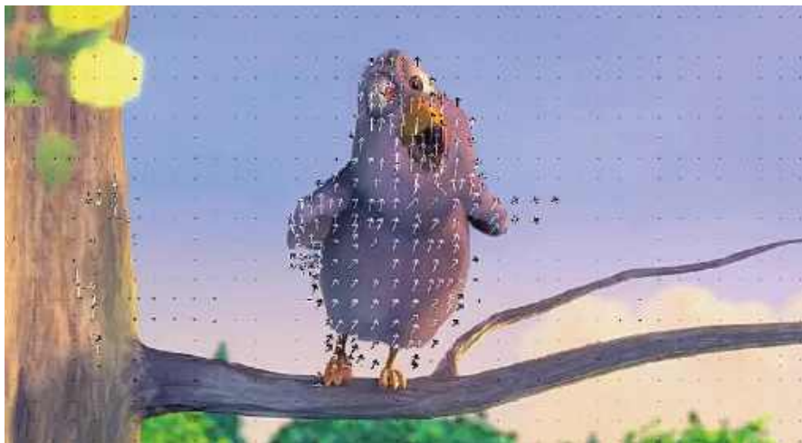
Ten obraz przedstawia wektory ruchu (w postaci strzałek), zaznaczone na pojedynczej klatce z filmu Big Buck Bunny (Blender Foundation, Peach Movie Project) kodowanego metodą H.264. Wektory ruchu są używane do opisanie sposobu przekształcania danego obrazu w kolejny, podczas kompresji filmów, patrz https://w.wiki/62xT .
