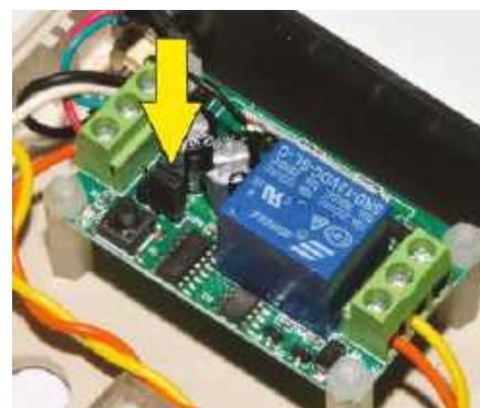
Rysunek 5. Użyty przeze mnie odbiornik do zdalnego sterowania ma zworkę konfiguracyjną (oznaczoną strzałką). W pierwszym ustawieniu przekaźnik załącza się tylko na czas naciśnięcia przycisku w nadajniku, w drugim ustawieniu przekaźnik trwale załącza się po jednym naciśnięciu przycisku i wyłącza po kolejnym naciśnięciu. Ja skorzystałem z drugiego ustawienia. Przycisk umieszczony na płycie drukowanej obok zworki umożliwia wprowadzenie do systemu kilku nadajników. Po prawej stronie znajduje się przekaźnik do ręcznego załączania oświetlenia. Należy zauważyć, że jego zaciski zostały zaizolowane – żadne połączenia sieciowe nie powinny być odsonięte
