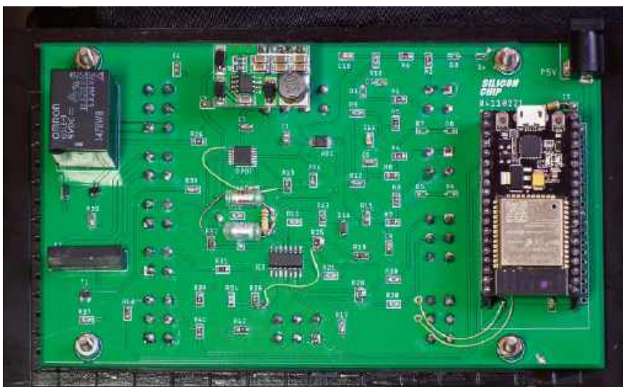
Większość elementów jest montowanych na spodzie płytki drukowanej. Prototyp na zdjęciu nie był wersją ostateczną i zawierał dodatkowe przewody i elementy
