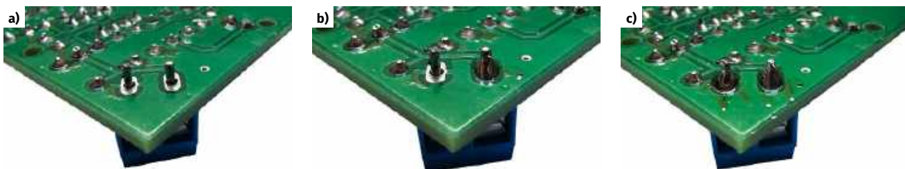
Fotografia 16. Poprawny montaż złączy śrubowych dla mikrofonów: a) włoż złącze do płytki tak, aby otwory do montażu mikrofonu skierowane były na zewnątrz urządzenia; b) przylutuj jedno z wyprowadzeń i upewnij się, czy złącze dobrze przylega do płytki; c) gdy wszystko jest w porządku, przylutuj drugie wyprowadzenie
