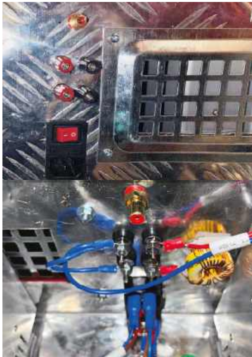
Fotografia 4. Tylny panel wzmacniacza, ze złączem wejściowym na górze, zaciskami wyjściowymi 2...4 \Omega poniżej i zaciskami wyjściowymi 8 \Omega tuż nad przetłaczanym i zabezpieczanym gniazdem wejściowym. Wentylator, którego używaliśmy, został wycofany, więc zastosowaliśmy nieco mniejszy, natomiast złącza wyjściowe to zaciski. Dolne wyjście dla obciążeń 8 \Omega ma dodatkowy dławik 75 \mu\text{H} , aby zapobiec skokowi w górnej części pasma przenoszenia, który mógłby uszkodzić głośniki wysokotonowe
