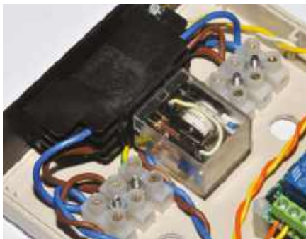
Rysunek 4. Na rysunku widoczne są listwy elektryczne z zaciskami śrubowymi dla połączeń wejścia i wyjścia zasilania sieciowego oraz odpowiednie otwory dla kabli. Te listwy ułatwiają podłączanie odbiornika w warunkach terenowych
