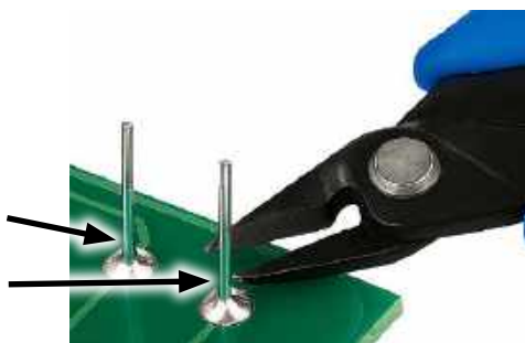
Rysunek 3. Właściwe miejsce cięcia nadmiaru wyprowadzeń po przylutowaniu komponentu. Po wykonaniu cięcia spoina powinna pozostać nienaruszona
