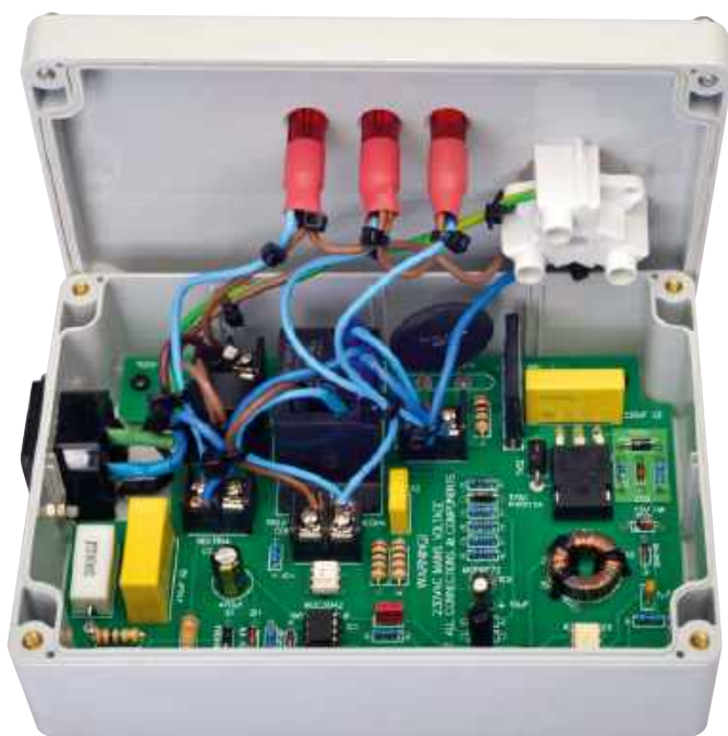
Zmontowane urządzenie przed zamknięciem pokrywy. Odpowiednia liczba opasek kablowych zapewnia, że nawet jeśli któryś przewód się zerwie, nie będzie się mógł zetknąć z innymi częściami układu, nie uszkodzi ich i nie stworzy zagrożenia porażeniem prądem
