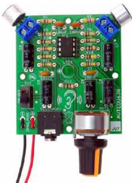
Fotografia 23. Poprawnie zmontowany układ Super Ucha. Widok płytki a) od strony komponentów; b) od strony lutowania
