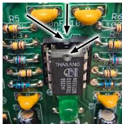
Fotografia 22. Przed zamontowaniem układu scalonego w podstawce należy upewnić się, że znaczniki kierunku montażu – na płytce, w podstawce i na układzie scalonym – znajdują się w tej samej pozycji
