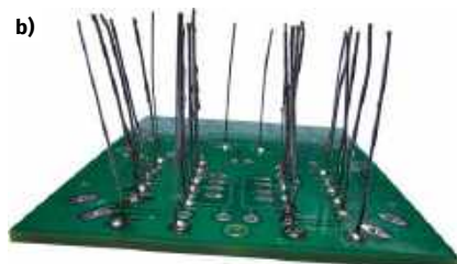
Fotografia 5. a) rezystory obostronnie zagięte, celem bezpiecznego obrócenia płytki o 180° i oparcia jej o blat; b) rezystory po procesie lutowania przyjaznego naprawom – przed przylutowaniem każde wyprowadzenie rezystora zostało ustawione pod kątem prostym do płytki; c) widok płytki po stronie lutowania, po ucięciu nadmiaru wyprowadzeń przylutowanych wcześniej komponentów
