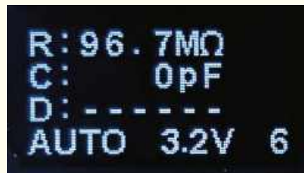
Zrzut 21. AUTO to tylko jeden z dziesięciu trybów, ale on jeden udowadnia wyższość opisywanej pęsety nad jej poprzednimi wersjami. Na jednej stronie pokazywana jest rezystancja, pojemność oraz polaryzacja i napięcie przewodzenia diody
