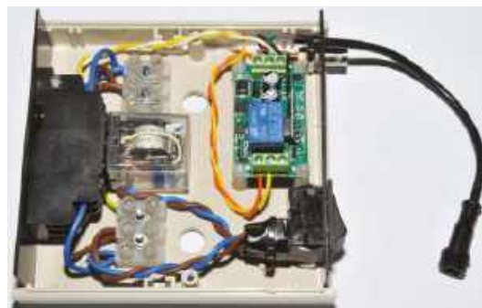
Rysunek 2. W systemie zdalnego sterowania o dużym zasięgu wykorzystany został niedrogi moduł odbiornika, przekaźnik sieciowy i kilka dodatkowych elementów, takich jak listwy połączeniowe, przetłącznik do ręcznego sterowania oświetleniem oraz złącze do anteny zewnętrznej. Do zasilania odbiornika wykorzystany został kabel z fabrycznie zaprawionym przyłączem sieciowym
