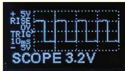
Zrzut 15: Bardzo przydatny jest tryb oscyloskopu, mimo że wykres sygnału ma tylko 100 pikseli w poziomie i 48 pikseli w pionie. Próbkowanie odbywa się z częstotliwością do 25 kHz, co wystarcza do badania sprzętu elektroakustycznego. Można ustawić różne tryby wyzwalania
