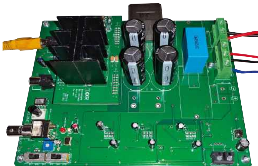
Fotografia 1. Płytkę ewaluacyjną IRAUDAMP9 z układem scalonym wzmacniacza klasy D (pod dużym radiatorem) i układami pomocniczymi. Jedynymi wymaganymi połączeniami są: wejście sygnału w lewym górnym rogu, wyjście głośnikowe w prawym górnym rogu i złącze zasilania. Poniżej znajdują się wejścia szyny zasilającej \pm 72 V...75 V DC. Jeśli używasz wskaźnika wysterowania, prawdopodobnie połączysz również jego przewody sygnałowe do dwudrożnego terminala głośnikowego
