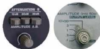
Dwa pasywne tłumiki w aparaturze pomiarowej (© 2022 Jos Verstraten)
