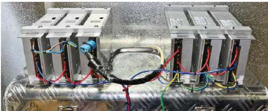
Fotografia 3. Połączenie szeregowe sześciu zasilaczy i okablowanie sieciowe. Należy zauważyć, że na tym początkowym etapie nie użyliśmy złączy zaciskanych. Nie są one bezwzględnie konieczne, ale jeśli są prawidłowo zaciśnięte, zapewniają bezpieczniejsze mocowanie i mniejsze ryzyko przypadkowych zwarcień. Nie oszczędzaj na opaskach kablowych po zakończeniu okablowania, zwłaszcza na wiązkach przewodów sieciowych
