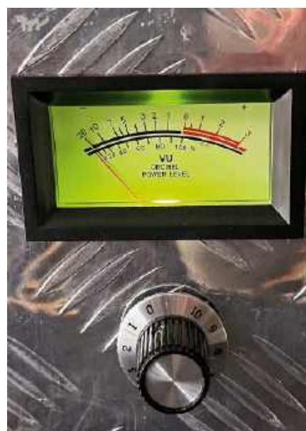
Fotografia 2. Wskaźnik wysterowania jest przydatny do sprawdzenia z jaką mocą jest wysterowany wzmacniacz, dlatego musi być skalibrowany dla konkretnej impedancji obciążenia
