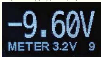
Zrzut 14: Stan początkowy w trybie miernika, w którym można mierzyć napięcia do 30 V o polaryzacji zarówno ujemnej, jak i dodatniej. Rozdzielczość wynosi 10 mV na zakresie 9,99 V i 0,1 V na wyższym zakresie
