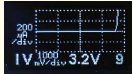
Zrzut 18: W trybie pomiaru diod nie są wykrywane diody podwójnie połączone antyrównolegle, np. LED-y dwukolorowe. Natomiast charakterograf bada elementy przy obu polaryzacjach. Skale napięcia i prądu można powiększyć, uzyskując więcej szczegółów
