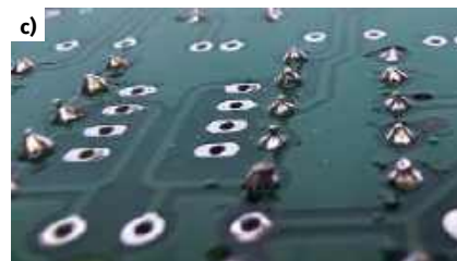
Fotografia 5. a) rezystory obostronnie zagięte, celem bezpiecznego obrócenia płytki o 180° i oparcia jej o blat; b) rezystory po procesie lutowania przyjaznego naprawom – przed przylutowaniem każde wyprowadzenie rezystora zostało ustawione pod kątem prostym do płytki; c) widok płytki po stronie lutowania, po ucięciu nadmiaru wyprowadzeń przylutowanych wcześniej komponentów
