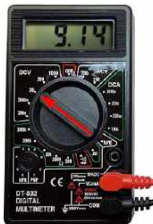
Fotografia 21. Pomiar na zaciskach 8 („plus”) i 4 („minus”) podstawki pod układ NE5532 wskazał poprawne napięcie baterii (bez znaku „-”, który sugerowałby błędną polaryzację). Można teraz odłączyć zasilanie i zamontować układ NE5532 w podstawce
