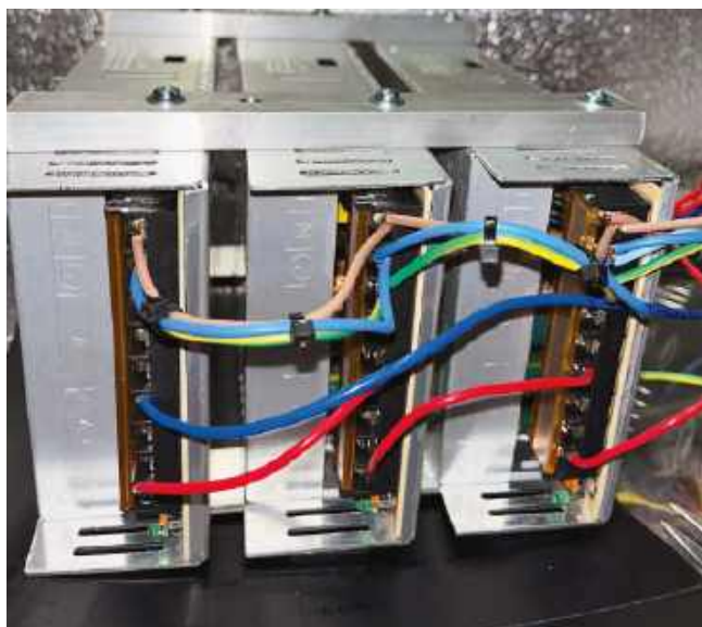
Fotografia 7. Lewy bank (ujemny) zasilaczy. Widać pomarańczowe potencjometry, które regulują napięcie wyjściowe zasilacza. Gruba szyna na górze wchodzi w dolną część obudowy (zasilacze są odwrócone po zainstalowaniu), aby umożliwić cyrkulację powietrza chłodzącego pod zasilaczami. Fotografia została zrobiona przed dodaniem wszystkich opasek kablowych. Każdy kabel powinien być spięty opaską, a sieć zasilająca powinna być oddzielona od pozostałego okablowania
