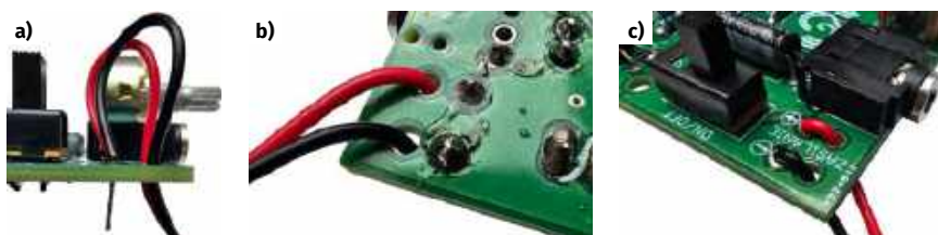
Fotografia 19. Kabelki złącza baterii należy: a) przeprowadzić przez otwory pomocnicze od strony lutowania, a odizolowane, splecione i pocynowane końce każdego z kabelków należy następnie umieścić we właściwych polach lutowniczych, pamiętając o zachowaniu właściwej polaryzacji (czerwony kabelek do plusa a czarny do minusa); b) przylutować kabelki do odpowiednich pól lutowniczych; c) pozbyć się pętli przewodów po stronie komponentów, wyciągając kabelki maksymalnie ku dołowi
