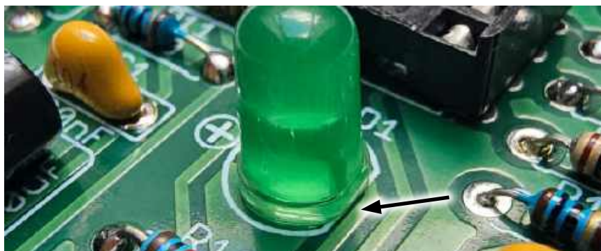
Fotografia 13. Poprawnie zamontowana dioda LED. Płaskie ścięcia na obwodzie podstawy diody LED, symbolizujące katodę, musi pokrywać się z fragmentem linii prostej w obrysie komponentu widocznym na płytce
