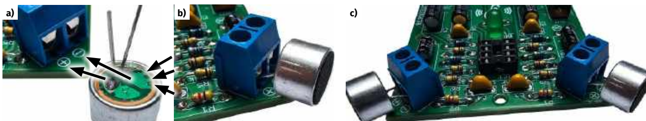
Fotografia 17. Poprawny montaż mikrofonów elektretowych w złączach śrubowych: a) polaryzacja mikrofonu elektretowego; b) mikrofon zamontowany w złączu śrubowym; c) oba mikrofony poprawnie zamontowane w Super Uchu
