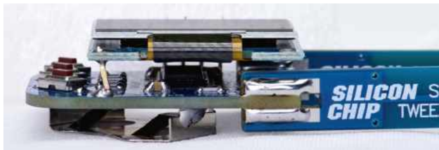
Na zdjęciu widać odstęp między modułem wyświetlacza a główną płytką drukowaną. Zwróćmy uwagę na pin w rogu wyświetlacza, pochodzący ze złącza męskiego „goldpin”, a użyty jako element dystansowy i wzmacniający. Zapobiega on wyginaniu się płytek względem siebie i powstawaniu zwarc między nimi
