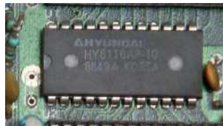
Układ pamięci SRAM o pojemności 2 KB używany w klonie NES. Pamięć SRAM jest znacznie szybsza, ale droższa niż DRAM, więc jest stosowana w małych objętościach, tak jak w pamięciach podręcznych L1 i L2 (od kilku kB do kilku Mb). Źródło: https://w.wiki/63EN
