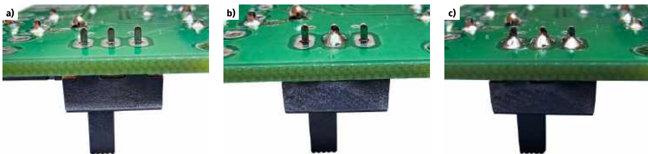
Fotografia 15. a) Poprawnie włożony do płytki przełącznik SW1; b) zanim przylutujesz wszystkie wyprowadzenia, przylutuj w pierwszej kolejności pin środkowy i sprawdź, czy komponent przylega prostopadłe do płytki. Jeśli wszystko jest w porządku przylutuj dwa pozostałe wyprowadzenia; c) tym sposobem przełącznik został poprawnie przylutowany i dobrze przylega do płytki
