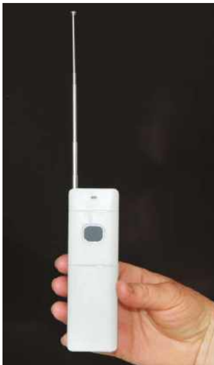
Rysunek 3. Wybierając odpowiedni zestaw do zdalnego sterowania o dużym zasięgu, należy upewnić się, że nadajnik jest znacznie większy od typowego breloczka do zdalnego sterowania i ma wysuwaną antenę
