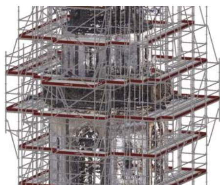
Rys. 3. Model 3D rusztowania budowlanego opracowany w oprogramowaniu wspierającym pracę w technologii BIM
