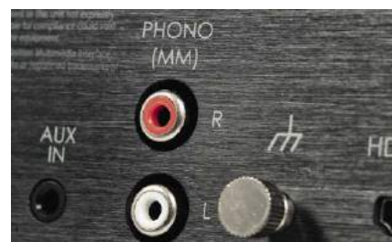
JBL nie przegapił popularności gramofonów, przygotował więc wejście MM. A odtwarzacz CD... podłączymy do wejścia liniowego.
