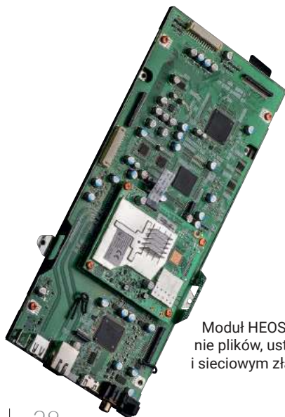
Przedwzmacniacz phono oraz DAC zainstalowano na jednej płycie
