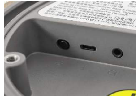
W dolnej stopce znajduje się również wejście mini-jack (zarówno dla sygnałów analogowych, jak i cyfrowych) oraz serwisowe USB.
