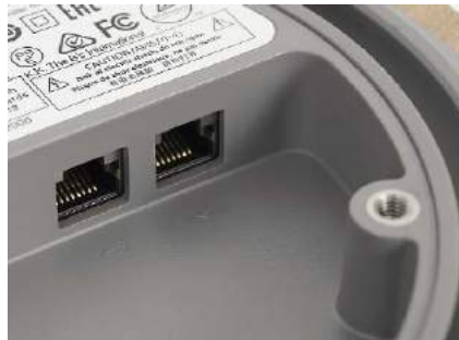
Oprócz gniazda zasilającego są dwa złącza sieci LAN; Balance może służyć jako tzw. „switch”, czyli rozgałęziacz sygnału sieciowego.
