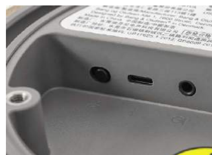
W dolnej stopce znajduje się również wejście mini-jack (zarówno dla sygnałów analogowych, jak i cyfrowych) oraz serwisowe USB.
