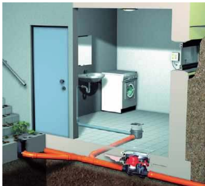
● Pomieszczenia piwniczne powinniśmy koniecznie wyposażyć w urządzenia przeciwwalowe. KESSEL
