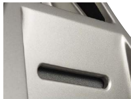
Głośnik średniotonowy pracuje w komorze z otworem w formie szczeliny, działającej podobnie jak system z elementem stratnym – nie chodzi o zwiększenie efektywności w zakresie niskich częstotliwości, ale o odciążenie głośnika.
