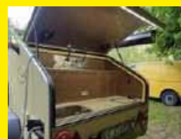
Zlewozmywak, lodówka, kuchenka. Po prawej stronie od nich zewnętrzny blat kuchenny, instalowany na postoju
