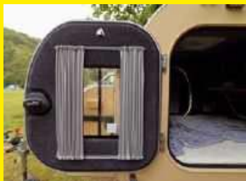
Drzwi to przykład dopasowania i elegancji; odsuwana szybka wraz z wentryzownikami i wentylatorem zapewni cyrkulację powietrza wewnątrz, a zasłonki skutecznie obronią przed słońcem
