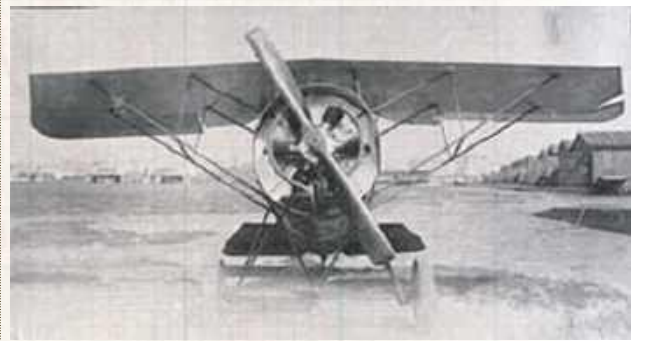
Pewną ciekawostką był samolot Morane. Był tzw. roulerem - miał skrócone skrzydła i wcale nie latał: służył do nauki kotowania na pasie. Dopiero potem młodzi lotnicy próbowali latać na m.in. Nieuportach...
