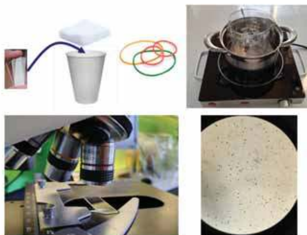
Ilustracja 3. Zdjęcia szkolnego układu pomiarowego. U góry, z lewej strony – pojemnik na detektor, z prawej – płyta grzewcza z garnkiem do wytrawiania. Na dole, z lewej strony – szkolny mikroskop, z prawej – obraz spód mikroskopu uzyskany telefonem komórkowym.
