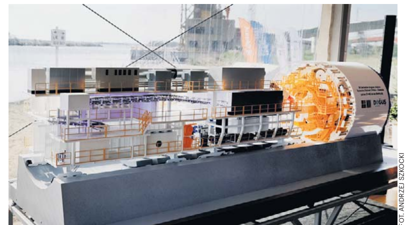
Model maszyny TBM, która będzie drążyła tunel pod Odrą. Średnica zewnętrzna będzie wynosiła niemal 15 m, a grubość obudowy 60 cm
