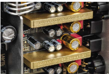
Baterie ultraprecyzyjnych rezystorów konwertera R2R są ukryte pod złotymi obudowami.
