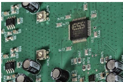
Największą atrakcją jest referencyjny przetwornik C/A ESS Technology ES9039MSPRO.
