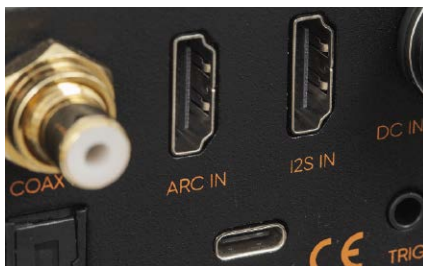
Sąsiadują ze sobą najnowocześniejsze gniazda wejściowe: USB, HDMI (z ARC) i wykorzystujące takie samo złącze I2S.
