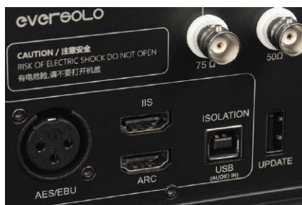
Jest nie tylko USB, ale także coraz popularniejsze HDMI z ARC i "hi-endowe" I2S.
