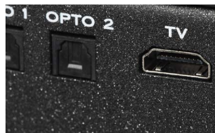
Coraz popularniejsze HDMI z ARC pozwala zintegrować system audio z telewizorem.
