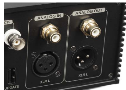
Są wejścia analogowe, również symetryczne XLR – DAC-Z10 ma tor zbalansowany.
