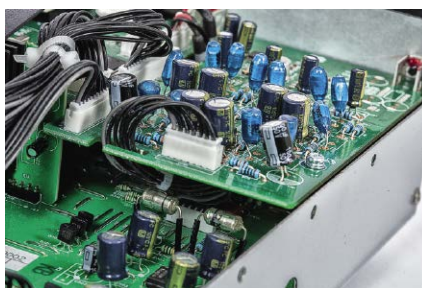
Przedwzmacniacz gramofonowy ma własną, dużą płytkę.
