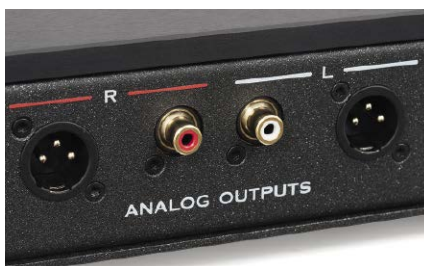
Wyjście analogowe jest dostępne jako RCA i XLR, bez regulacji głośności.
