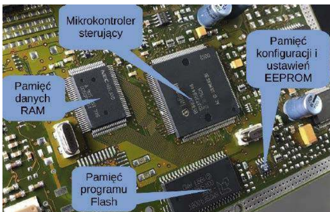
Fotografia 2. Fragment płytki sterownika silnika samochodowego – ECU, z zaznaczonymi kluczowymi komponentami
