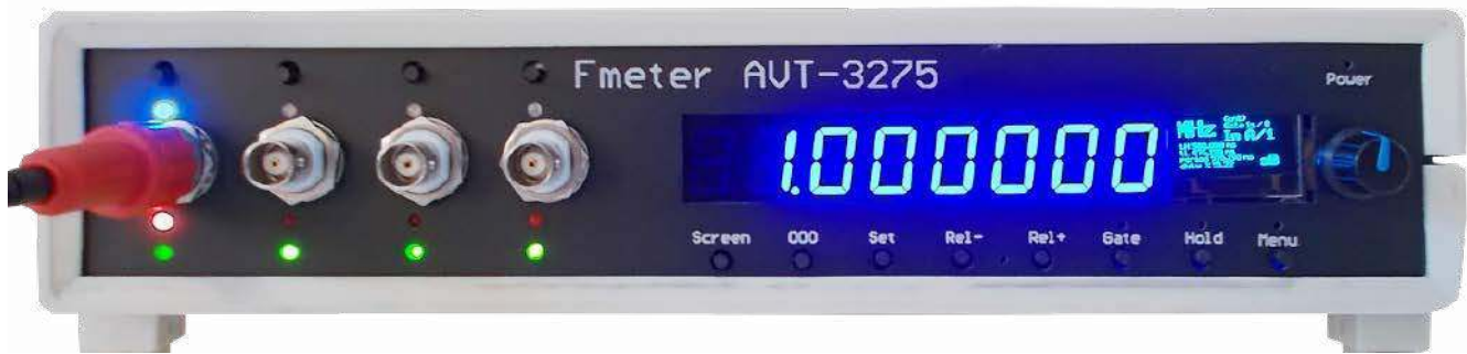
Fotografia 1. Uruchomiony miernik częstotliwości i czasu z zamontowanymi wzmacniaczami sygnałów wejściowych
