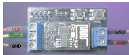
Rysunek 4. Kontroler RGB podłączony do modułu LED (po lewej stronie) i zasilania (po prawej stronie)
