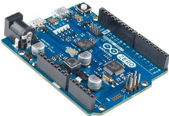
Fotografia 1. W wielu płytках rodziny Arduino stosowane są mikrokontrolery serii SAM D21, np. Arduino Zero
