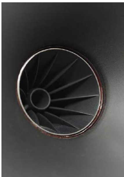
Membrana przetwornika wysokotonowego znajduje się głęboko – za membraną nisko-średniotonowego i za jego układem magnetycznym, przez środek którego przechodzi skomplikowany „lejek”.
