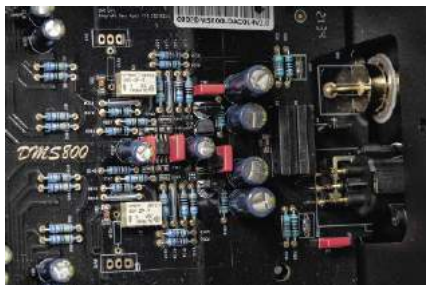
Układ gniazd analogowych wymusił przygotowanie nowych płytek, DMS-800PV nie jest prostym rozwinięciem modelu DMS-700 .
