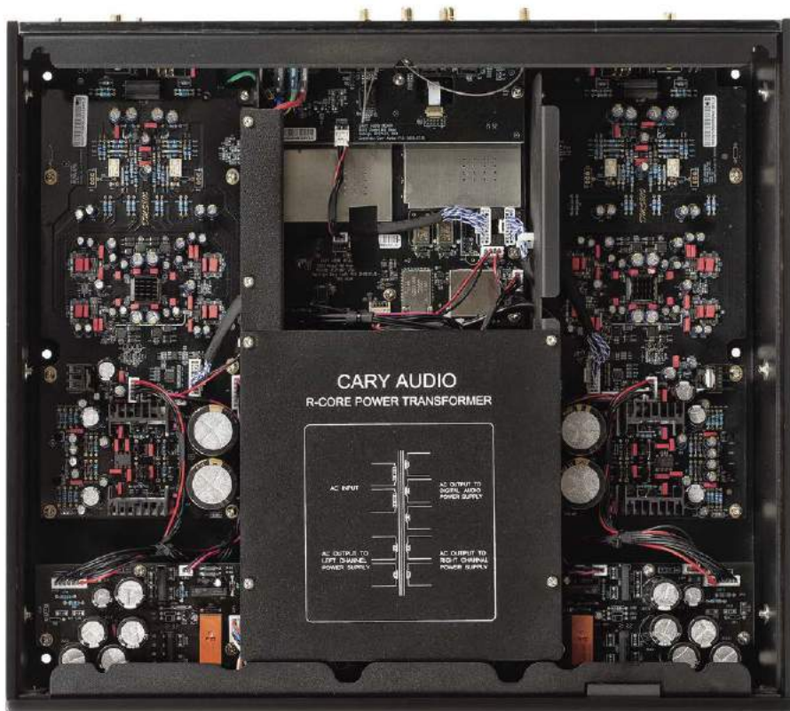
Kanały lewy i prawy odseparowano mechanicznie i elektrycznie, rozdzielając je wspólnym transformatorem zasilającym oraz układami komunikacyjnymi.
