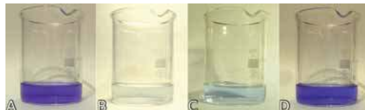
Fot. 7 – Zaobserwowane zmiany; A – roztwór w stanie wyjściowym, B – roztwór oświetlony lampą, C – roztwór tuż po wyłączeniu lampy, D – roztwór po upływie 60s
