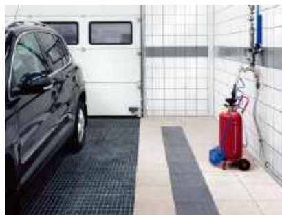
🔧 Gres techniczny jest odporny na ścieranie, antypoślizgowy i łatwo go wyczyścić. Przy układaniu kluczowe jest zastosowanie fugi odpornej na zabrudzenia i sól. TUBĄDZIN
