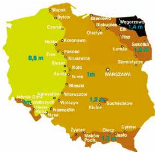
☞ Strefy przemarzania gruntu w Polsce. W zależności od regionu, wynoszą od 0,8 m do 1,4 m.
