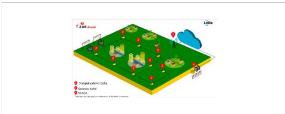
Rys. 3. Struktura sieci SN z zastosowaniem łączności w standardzie LoRa®
