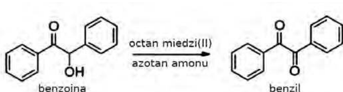
Rys. 3 – Schemat reakcji syntezy benzilu
