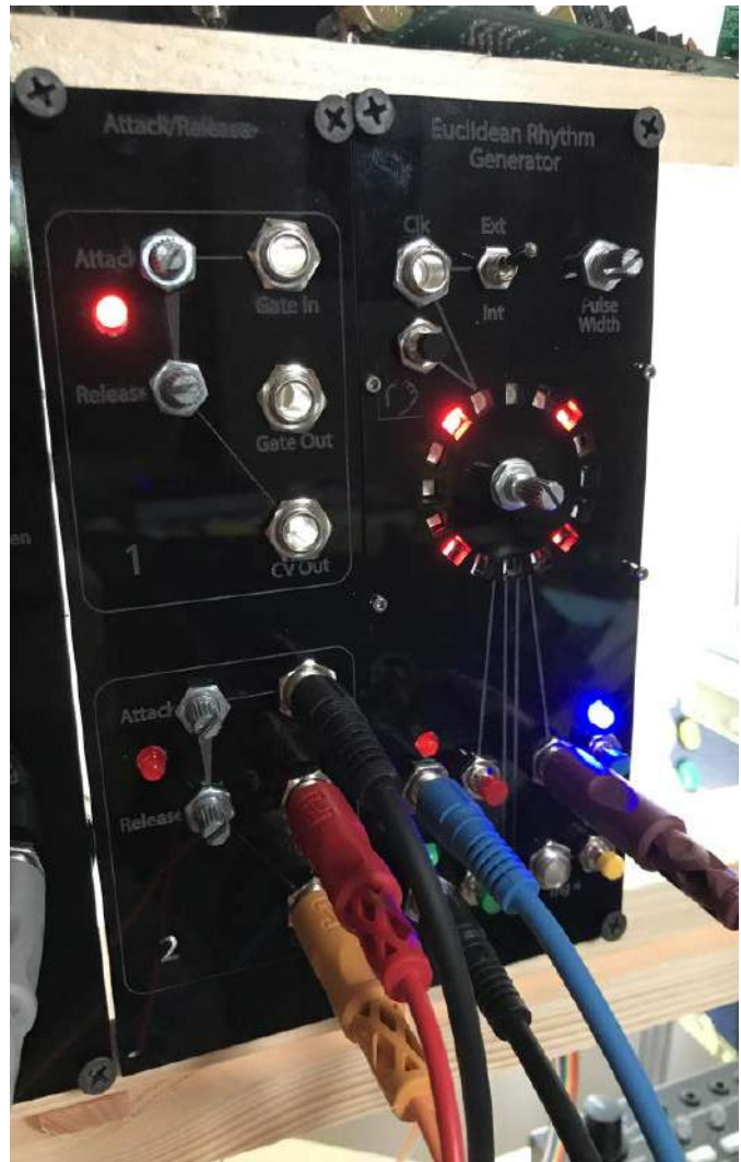
Fotografia 6. Gotowy moduł, zainstalowany i podłączony w syntezatorze
