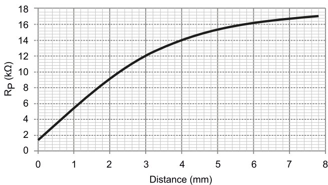
Rysunek 6. Przykładowa zależność rezystancji wypadkowej Rp układu rezonansowego od odległości cewka-obiekt ( https://bit.ly/3qYDfPz )
