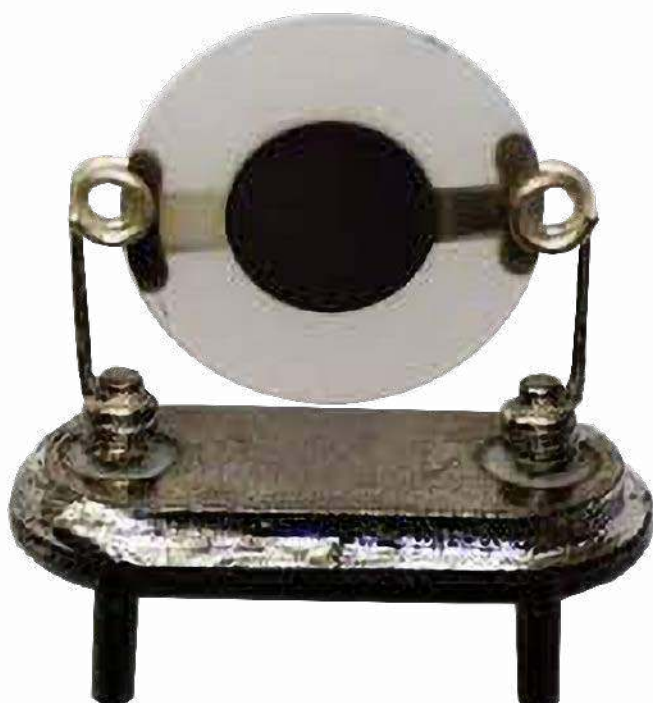
Fotografia 3. Widok rezonatora kwarcowego typu AT-CUT w obudowie HC49 po zdjęciu metalowej pokrywki ( https://bit.ly/3EjdzBR )
