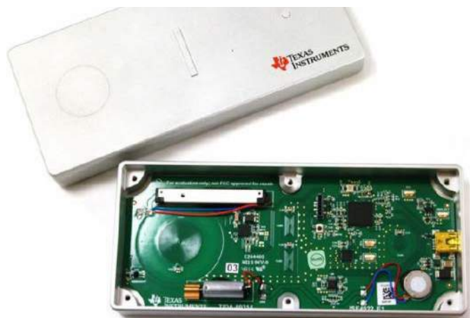
Fotografia 2. Przykładowe zastosowanie przycisków indukcyjnych – zestaw ewaluacyjny frontendu LDC marki Texas Instruments ( https://bit.ly/3HI9mJY )
