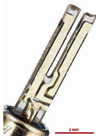
Fotografia 5. Płytki kwarcowe rezonatora „zegarkowego” typu tuning fork ( https://bit.ly/3pqlwd )
