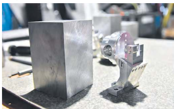
Po lewej „surowy”, aluminiowy blok. Po prawej gotowy element, który z niego powstał, wykonany w precyzyjnej obrabiarence.
