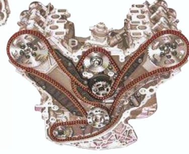
W późniejszych odmianach zastosowano już układ dwóch łańcuchów, co niewiele zmienia w kwestii łatwości wymiany.
