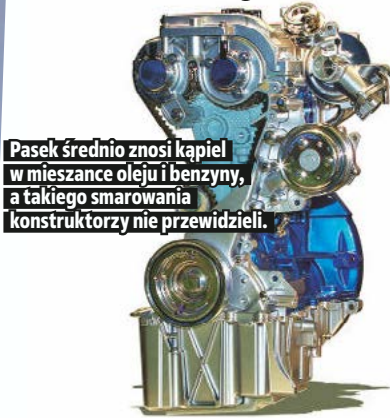
Wymiana droższa niż części, bo niemal zawsze trzeba wyjąć silnik spod maski.
