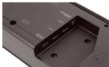
Wejścia HDMI są nawet dwa, ale najważniejsze jest wyjście z systemem eARC.
