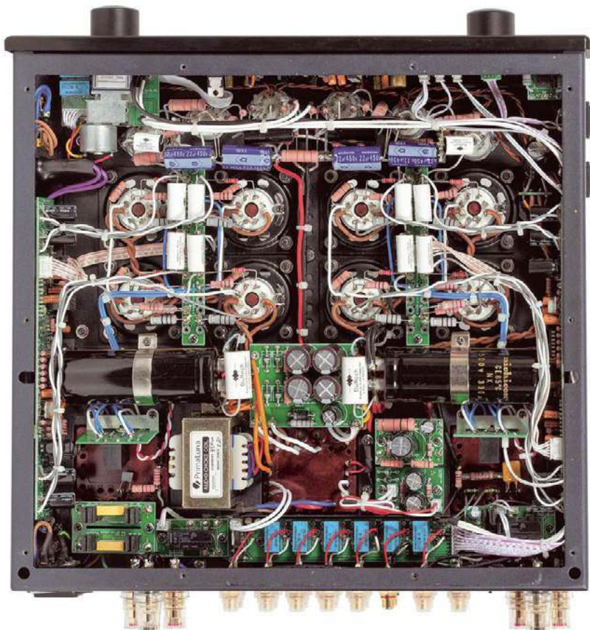
Część połączeń wykonano metodą punkt-punkt, ale sporo układów zmontowano na płytkach drukowanych.
