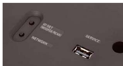
Na dolnej ścianie znajdziemy złącze USB, jednak przygotowane tylko do funkcji serwisowych.
