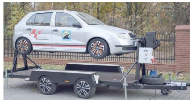
W ramach projektu dostępny jest również symulator dachowania oraz zderzeń
