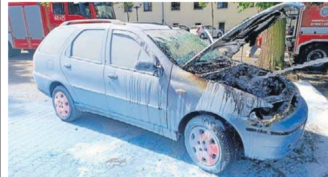
Prawdopodobną przyczynę wybuchu ognia było zwarcie instalacji elektrycznej w komorze silnika
