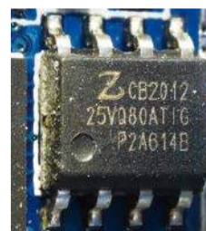
Rysunek 25. Układ pamięci Flash ZB25VQ80A1TG 8 Mb
