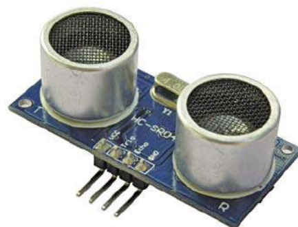
Rysunek 3. Czujnik ultradźwiękowy HC-SR04
