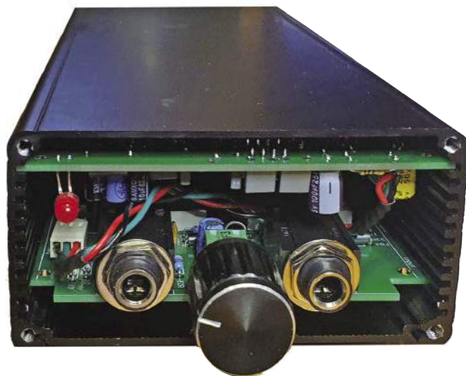
Widok wnętrza „nowego” Super-Kodeka z dodaną dole płytką tłumika. Jest przeznaczona do wsuwania w prowadnice krawędziowe w zalecanej aluminiowej obudowie Hammond 1455N2201BK.
