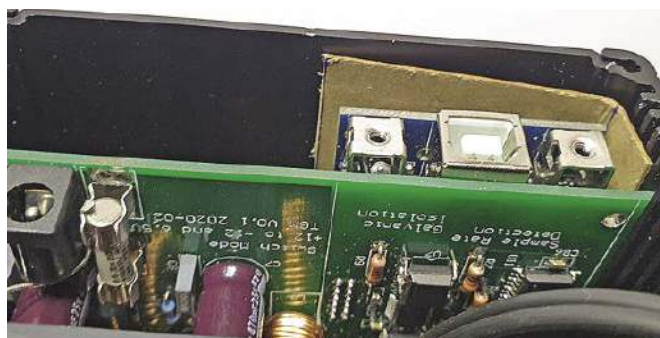
Kawałek materiału izolacyjnego, takiego jak preszpacing, umieszczony w sposób pokazany na fotografii, zapewni, że MCHStreamer będzie zawsze odizolowany od obudowy.
