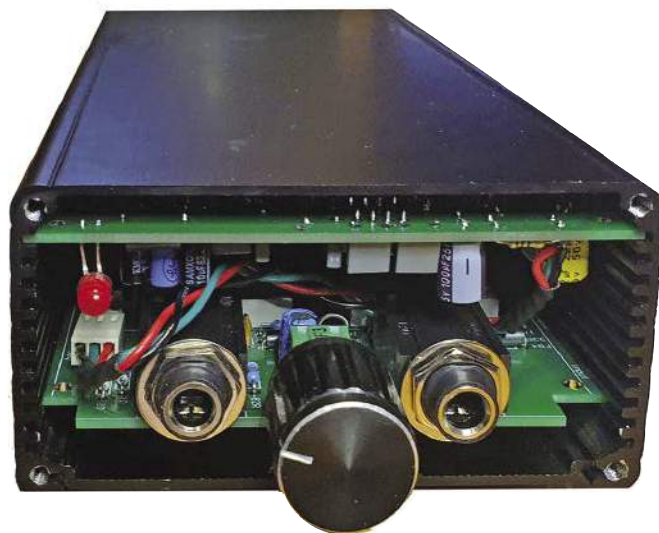
Widok wnętrza „nowego” Super-Kodeka z dodaną na dole płytką tłumika. Jest przeznaczona do wsuwania w prowadnice krawędziowe w zalecanej aluminiowej obudowie Hammond 1455N2201BK.
