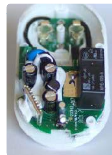
Rysunek 8. Elementy wewnętrzne modelu TRÅDFRI firmy Ikea
