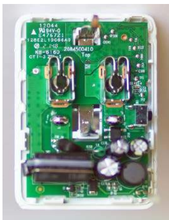
Rysunek 27. Kotki zasilające na środku są przylutowane
