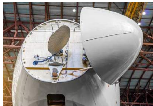
Radar meteorologiczny Dopplera montowany w nosie samolotu
