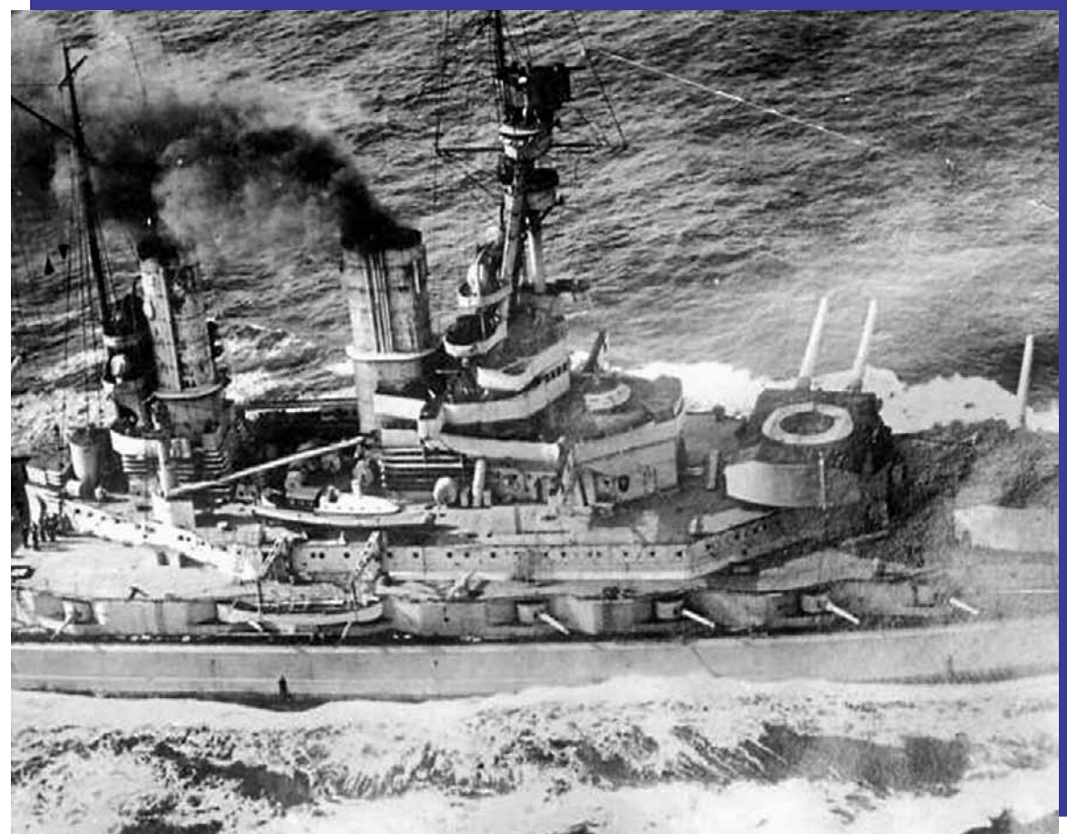
Okręt liniowy „Baden”. Okręty typu Ersatz Yorck miały być uzbrojone w podobny sposób, czyli w 8 dział kalibru 380 mm.
