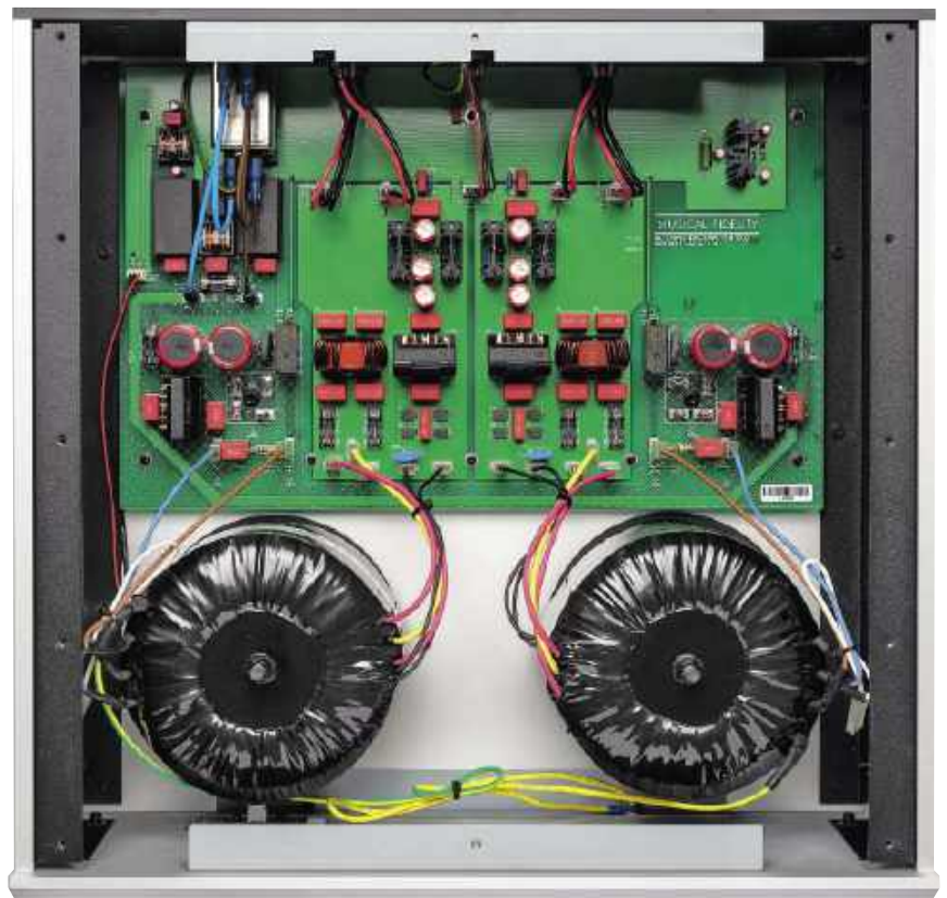
Obydwa zasilacze zbudowane są w konwencji dual-mono – z parą transformatorów toroidalnych i towarzyszących im filtrów. PAS ma oczywiście większe wymagania, więc i jego zasilacz jest bardziej wydajny, a połączenie obejmuje aż pięć kabli. Aby jednak nie zużywać energii elektrycznej niepotrzebnie (końcówka ma duży pobór prądu spoczynkowego), mniejsza sekcja służy oszczędnej sekcji czuwania.
