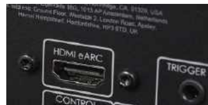
Złącze HDMI (ARC) dodano w nowej wersji "plus".
