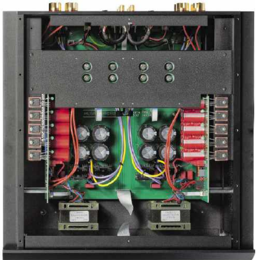
Z tyłu znajduje się sekcja lampowa, następnie sygnał jest prowadzony do dwóch niezależnych bloków końcówek mocy.
