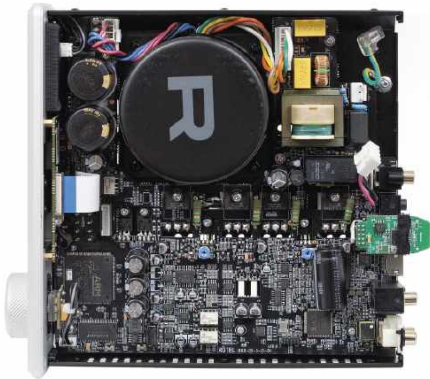
Mimo kompaktowych rozmiarów, DX-5 ma układy liniowe zarówno w końcówkach, jak i w zasilaczu.
