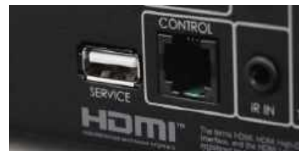
Złącza LAN i USB pełnią rolę sterująco-serwisową.
