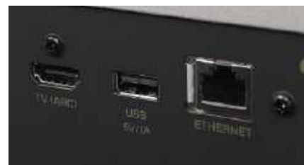
Sekcja cyfrowa obejmuje HDMI (ARC) i strumieniowanie.
