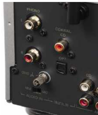
Przedwzmacniacz gramofonowy pracuje z wkładkami MM oraz MC.
