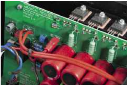
Tuż przy końcówkach znajdują się kondensatory zasilacza.
