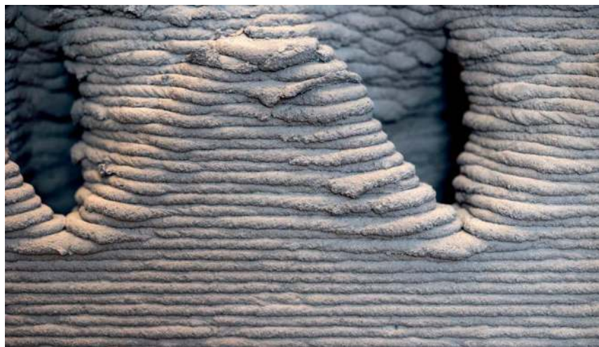
Pierwsze podwodne wydruki. Dzięki tej technologii mogłyby powstawać na dnie oceanu całe budynki.
