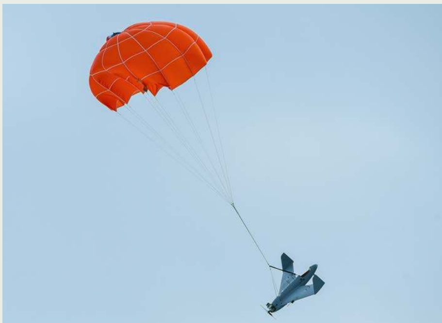
Szerszeń OWA/FO w czasie testów – widoczny spadochron służący do odzyskiwania BSP w czasie treningu.
