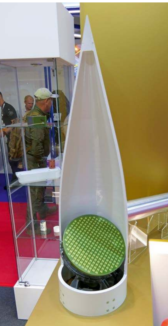
Model opracowywanej przez WITU radiolokacyjnej głowicy naprowadzającej dla przeciwlotniczych pocisków raketowych. Urządzenie przeszło już pierwsze testy na stanowisku laboratoryjnym.
