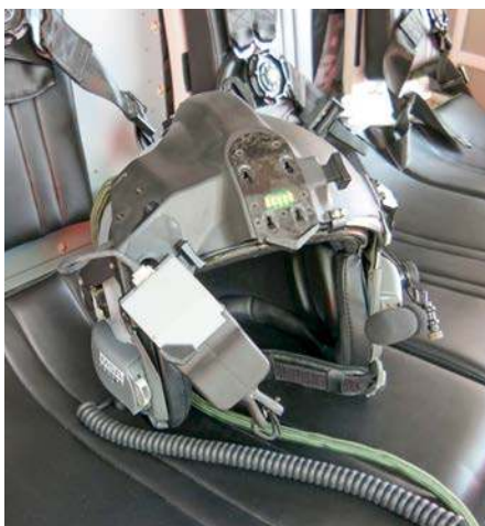
Monookularowy celownik napełmowy AW109M będzie nieocenioną pomocą w szkoleniu pilotów śmigłowców AH-64E i AW149.
