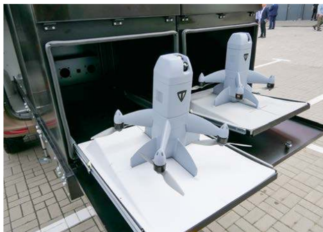
Kontener stanowiący platformę startową dla dronów przechwytyjących TI-2 EOS.
