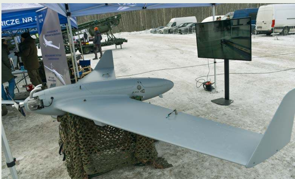
Bezzałowiec jest napędzany silnikiem spalinowym ze śmigłem ciągnącym.
