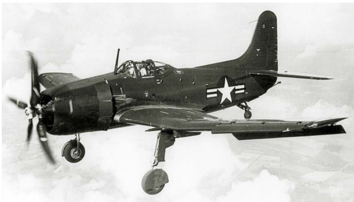
Drugi prototyp XBTC-2 (BuNo 31402) w locie z wysuniętym podwoziem, slotami i klapami (widać wychylone klapy duplex) podczas prób w NATC na początku 1947 roku. Maszt antenowy przeniesiono przed wiatrochron. Prototyp ten rozbił się 17 marca 1947 roku podczas prób korkociągu.
