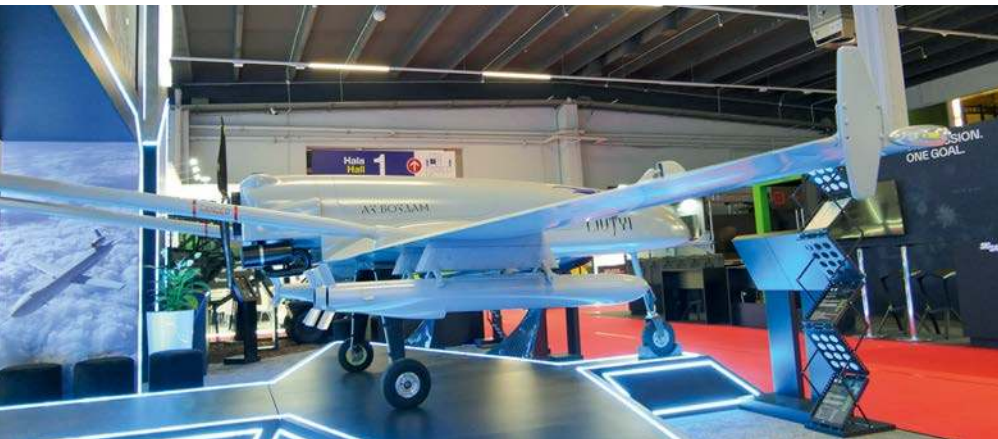
Ukraiński dron dalekiego zasięgu An-196 Lutyj z podwieszonymi pod skrzydłami niewielkimi pociskami manewrującymi o prędkości około 500 km/h i zasięgu 200 km.
