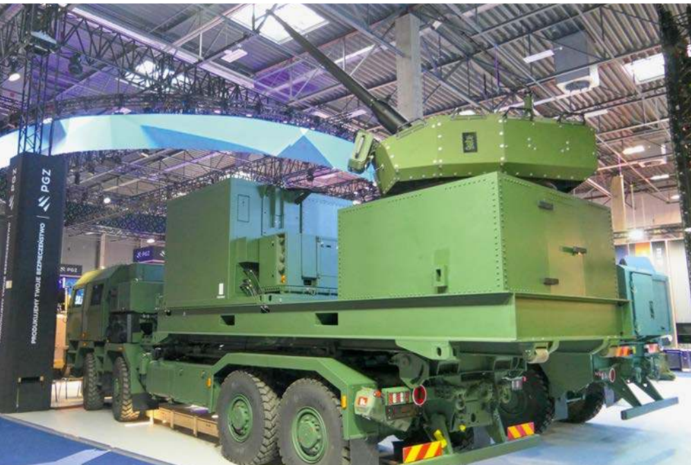
Jednym z najważniejszych elementów ekspozycji systemu antydronowego San był wóz ogniowy z bezzałogową wieżą Kongsberg RT20 MCT, którą osadzono na podwoziu Jelcza.
