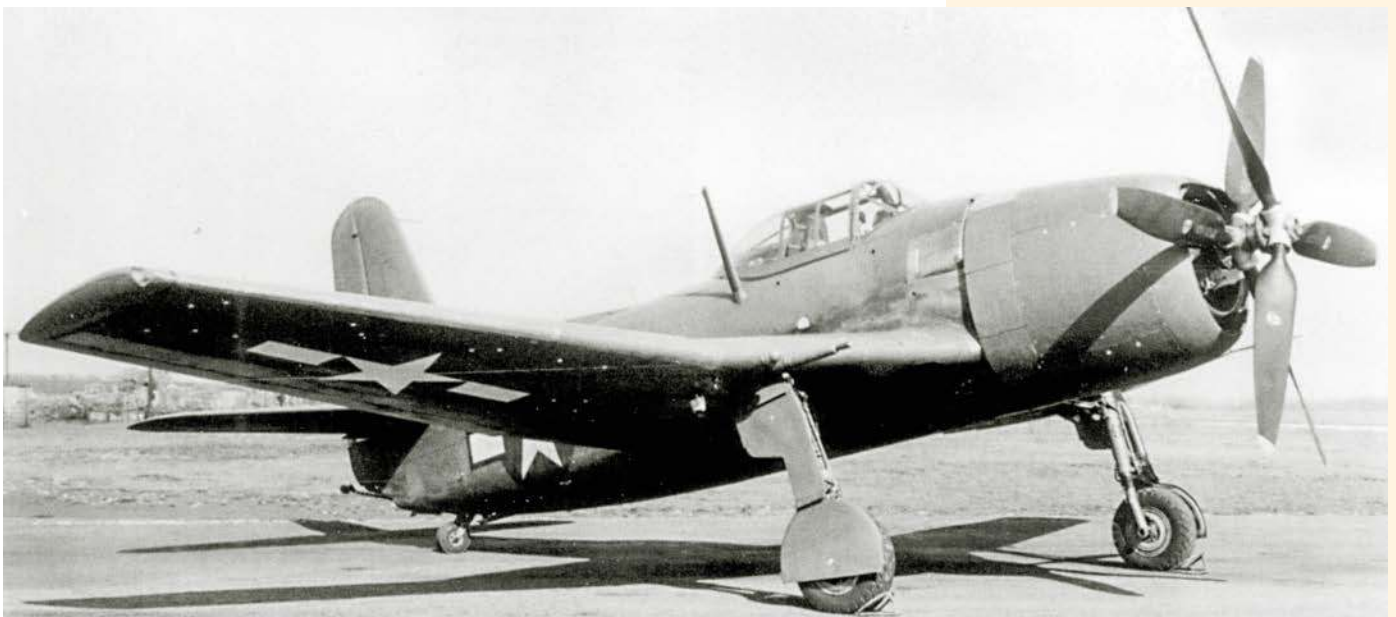
Drugi prototyp XBTC-2 (BuNo 31402) ze skrzydłami Model B sfotografowany 12 lutego 1946 roku. Samolot był napędzany silnikiem R-4360-14 (czyli seryjną, dopracowaną wersję R-4360-8A) ze śmigłem Aero products. Zwraca uwagę maszt antenowy umieszczony na kadłubie po prawej stronie kokpitu.
