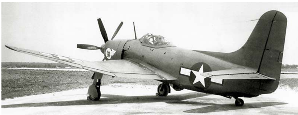
Pierwszy prototyp XBTC-2 (BuNo 31401) ze skrzydłami Model A sfotografowany 28 kwietnia 1945 roku. W spodzie kadłuba za komorą bombową widać uchylony wylot powietrza z chłodnic oleju. Skrzydła Model A miały cztery segmenty kłap szczelinowych na krawędzi spływu centroplata i sekcji zewnętrznych.
