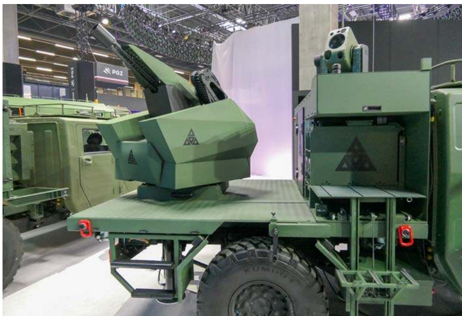
Element systemu San , który jest znany szerszej publiczności jako „Potwór z Tarnowa”. Tym razem pokazano bardziej dopracowaną wersję wieżyczki WLKM kal. 12,7 mm, która otrzymała rozbudowane magazyny amunicji po bokach oraz nową głowicę celowniczą firmy Etronika.
