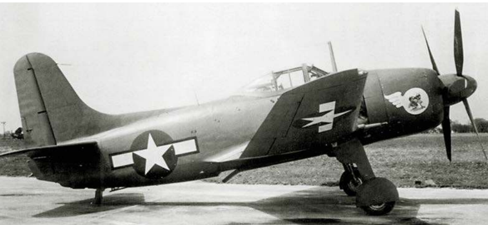
Pierwszy prototyp XBTC-2 (BuNo 31401) ze skrzydłami Model A sfotografowany 28 kwietnia 1945 roku. W spodzie kadłuba za komorą bombową widać uchylony wylot powietrza z chłodnic oleju. Skrzydła Model A miały cztery segmenty kłap szczelinowych na krawędzi spływu centroplata i sekcji zewnętrznych.
