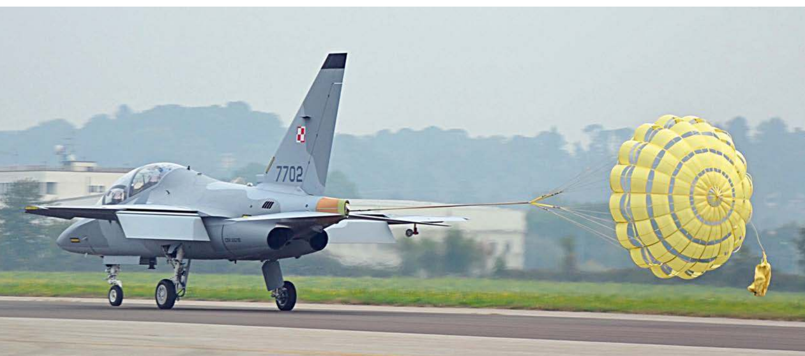
W polskich M-346 Bielik zamontowano spadochron hamujący w zasobniku umieszczonym u nasady usterzenia pionowego.
