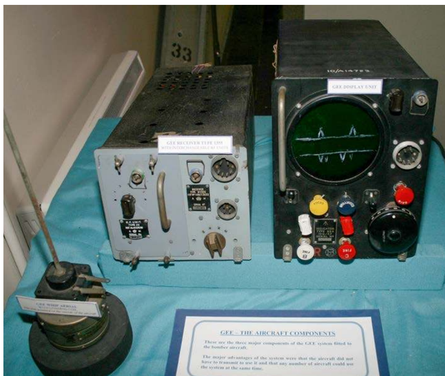
Pokładowe urządzenia brytyjskiego systemu radionawigacyjnego Gee (od lewej): antena prętowa, odbiornik R1355 i lampowy oscyloskop 62A, na którego ekranie wyświetlane były impulsy z naziemnych stacji nadawczych.
