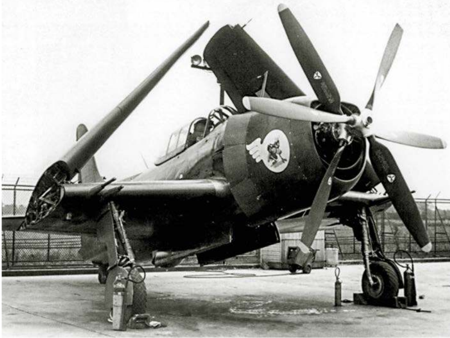
Pierwszy prototyp XBTC-2 (BuNo 31401) ze skrzydłami Model A sfotografowany 27 lipca 1945 roku. Samolot ma już śmigło Aero products bez kołpaka. Widać otwarte drzwi komory bombowej w spodzie kadłuba.
