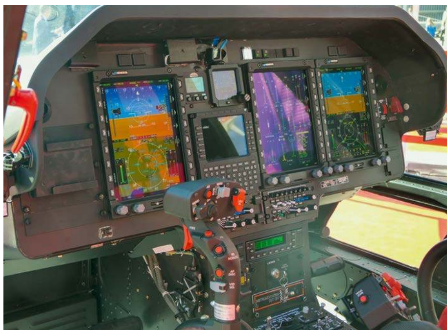
Kokpit śmigłowca AW109 jest wyposażony w trzy wyświetlacze ciekłokrystaliczne, z których prawy i lewy odpowiadają za prezentację parametrów lotu, środkowy zaś jest wielofunkcyjny.
