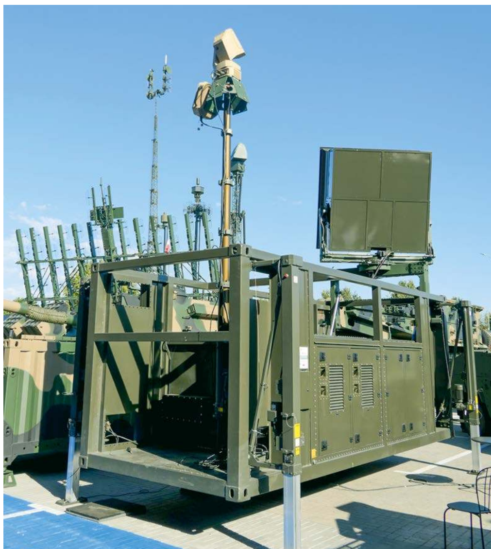
W Kielcach po raz pierwszy zaprezentowano publicznie demonstrator polskiego systemu antydronowego Rozmaryn , który wykorzystuje impulsy skoncentrowanej energii elektromagnetycznej wysokiej częstotliwości.
