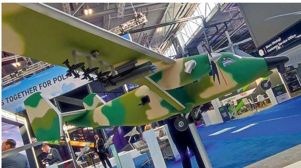
Model samolotu M28 z elementami systemu do zwalczania BSP. Zwracają uwagę podwieszone pod skrzydłami drony przechwytyjące i wyrzutnia kierowanych pocisków rakietowych APKWS kal. 70 mm.
