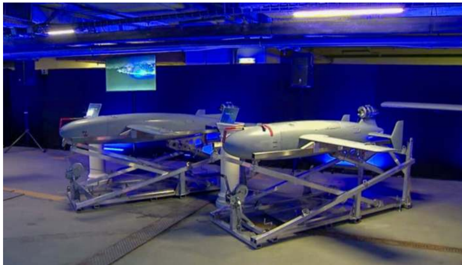
Dwa modele ukraińskiego drona odrzutowego BARS, którego powstanie sponsorowały Niemcy. Wariant BARS-SM jest wyraźnie grubszy niż wersja standardowa i zapewne zabiera więcej paliwa.
