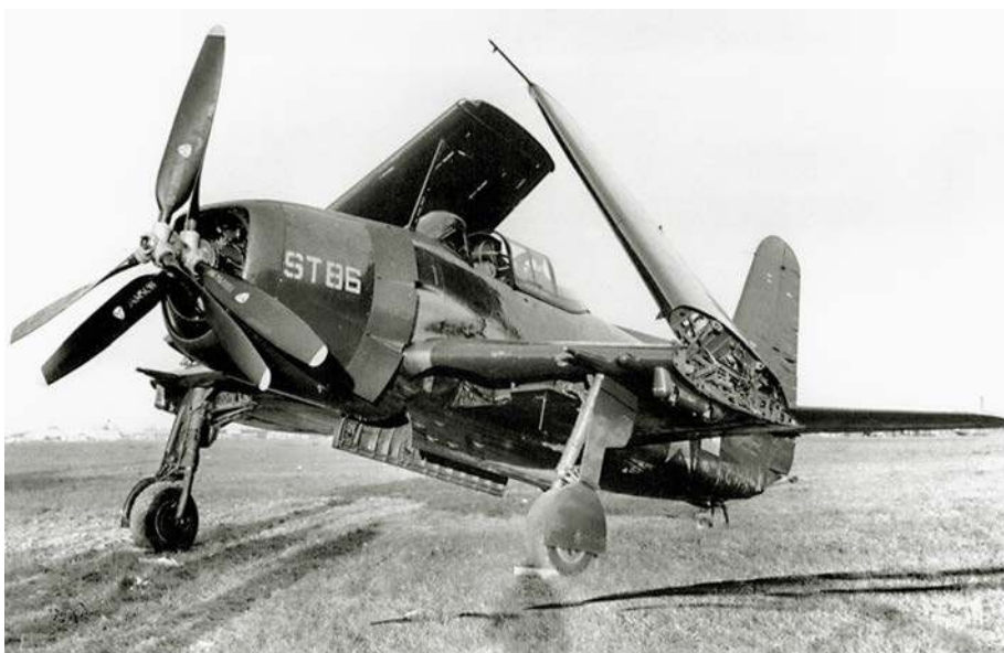
Pierwszy prototyp XBTC-2 (BuNo 31401) ze skrzydłami Model B podczas prób w NATC w listopadzie 1946 roku. Samolot był oznaczony numerem ST86, gdzie litery ST oznaczały Service Test Division . Widać otwarte drzwi komory bombowej w spodzie kadłuba.
