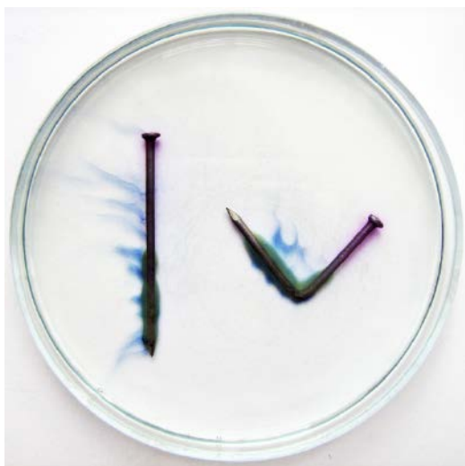
7. Przyspieszona korozja zachodzi w miejscach obróbki mechanicznej (ostrze i zgięcie gwoździa)
