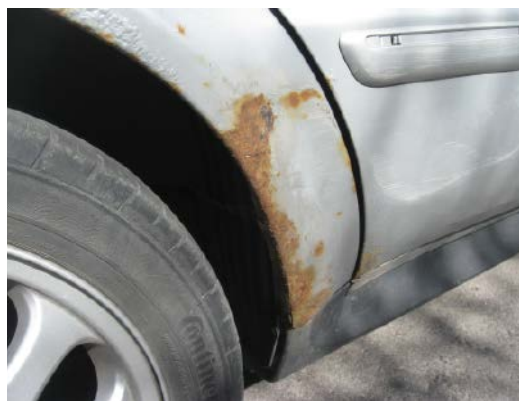
2. Pęcherze w górnej części nadkola świadczą o postępującej korozji podpowierzchniowej, rdza widoczna poniżej to efekt sypania soli na drogi
