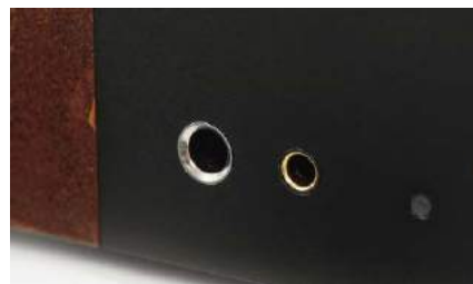
Słuchawki podłączymy do dwóch wyjść – klasycznego 6,3-mm gniazda oraz 4,4-mm zbalansowanego (tzw. Pentaconn).
