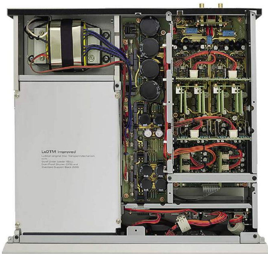
Układy wewnętrzne są podzielone na kilka sekcji i odseparowane ekranami. Górny pokład zajęła sekcja analogowa, cyfrowa znajduje się na dole.
