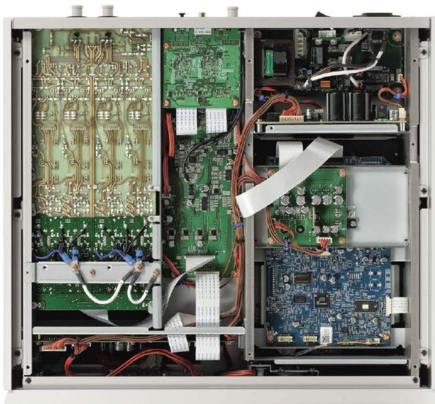
Po odkręceniu dolnej ścianki pojawia się dostęp do elektroniki sterującej i sekcji cyfrowej.
