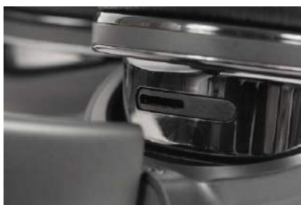
Słuchawki zostały wyposażone w rozbudowany zestaw mikrofonów; część służy do rozmów telefonicznych, część systemowi redukcji hałasów.
