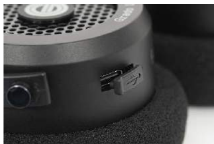
Złącze do ładowania akumulatorów ukryto pod gumową zatyczką.
