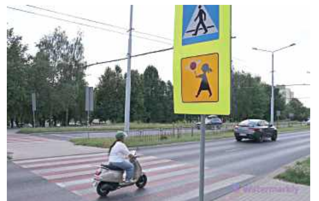
Duży, podwójny znak i biało-czerwone oznakowanie poziome na przejściu na Czubach. To przejście jest oznakowane znacznie lepiej
